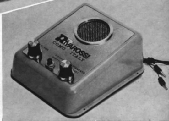
Abb. 199. Der Geräusch-Generator, an dessen zwei Potentiometern sich Auspuff-Folge und -Lautstärke einstellen lassen; in der Mitte der Drucktaster zur Pfeifenbetätigung.
