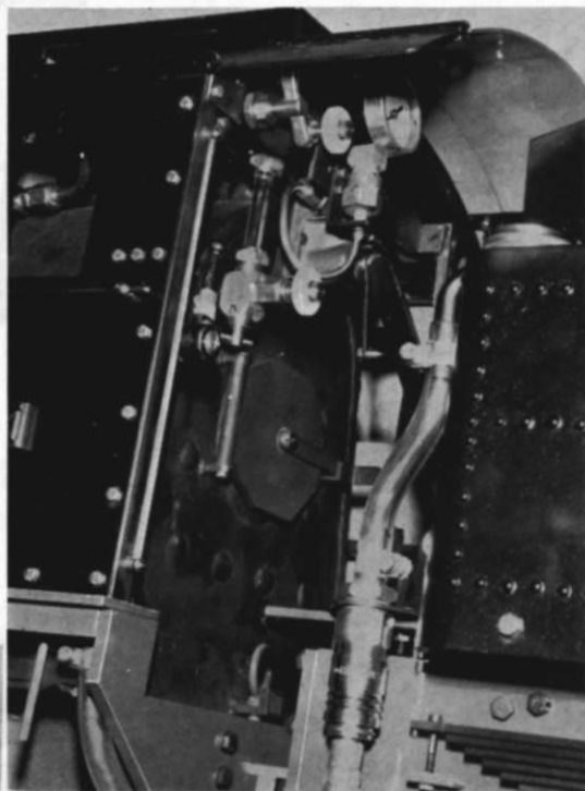
5“ Abb. 261. Ein dreiachsiges „Maschinengestell“ als Selbstbau-Grundlage (s. Haupttext).
