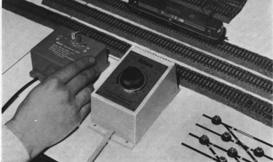
H0 Abb. 189. Drei sofort lieferbare Neuheiten auf einen Blick: links der Magnetartikel-Trafo; daneben das Elektronik-Fahrpult; rechts erkennt man noch einige Weichenschalter (s. Abb. 190), eingebaut in ein Gleisbildstellpult.
