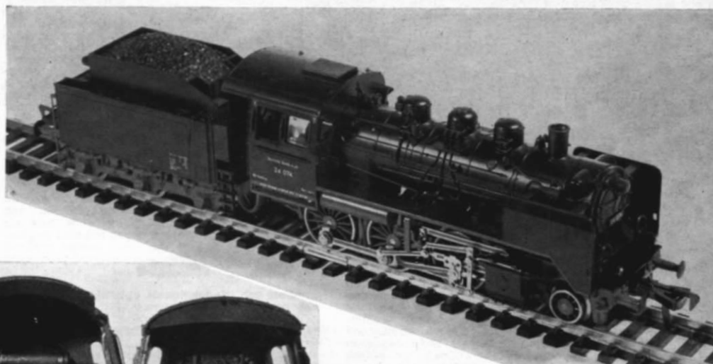
H0 Abb. 38 u. 39. Das „Steppenferd“ der BR 24 als feindetailliertes Fleischmann-Modell mit Tenderantrieb — genau im Maßstab 1:87 und nicht mehr so voluminös und „primitiv“ wie die 1:82-Vorgängerin vor gut 20 Jahren (s. Vergleichsaufnahme links).
