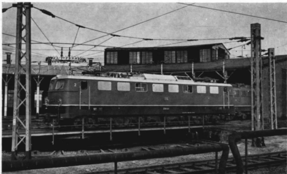
Abb. 5. Eine „Spinne“ im Bw Bebra mit den Abspannmasten im Vordergrund. Die Abspannung auf der gegenüberliegenden Seite erfolgt z. T. an den Stützfeilern der Lokschuppenfront; in diesem Falle müssen die Zugkräfte durch lange Winkelleisen o. ä. über eine möglichst große Fläche verteilt werden. (Foto: K. D. Holzborn, Heilbronn)
