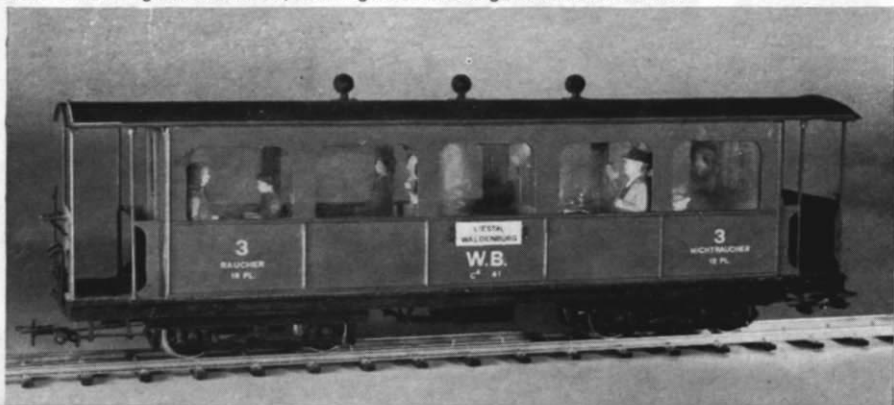
Abb. 3. Ein vierachsiger Personenwagen der Waldenburgerbahn; jedes Drehgestell besteht lt. Angabe des Erbauers aus 60 gelöteten Teilen, der Wagenkasten aus geklebtem Aluminium.
