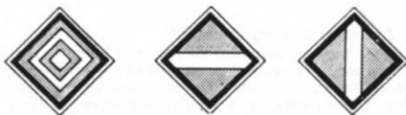
Abb. 7. Links: Das Signal „El 6“ (Wiedergabe in 0-Größe) bedeutet „Halt für Fahrzeuge mit Stromabnehmer“, ist blau/weiß gehalten und wird vor nicht überspannten bzw. abgeschalteten Gleisabschnitten angebracht (s. Haupttext).
