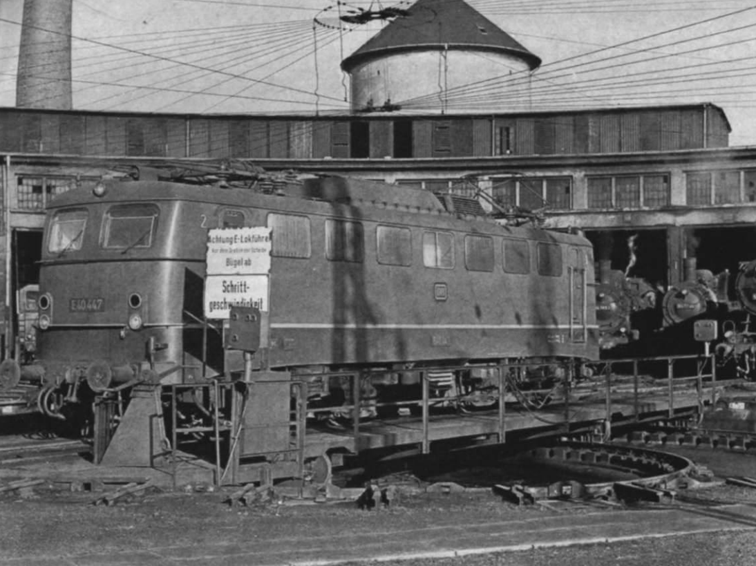
Abb. 1. Hier haben wir die im Haupttext erwähnte Situation, daß sich Dampf- und Elloks ein ursprüngliches Dampflok-Bw „teilen“ müssen. Die Drehscheibe ist mit Fahrdrähten samt Tragseilen überspannt, woraus sich eine „Doppelspinne“ (s. Haupttext) ergibt. Man erkennt, daß die Dampflok-Schuppengleise nicht überspannt sind. Wichtig: das Schild, das die Ellok-Führer zum Senken der Bügel auffordert.
