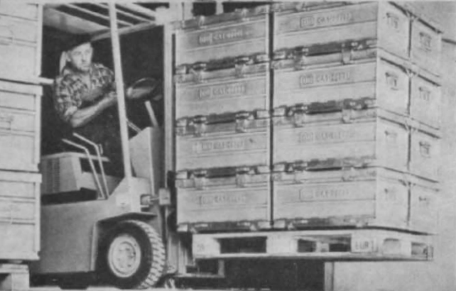
Abb. 4. Dieser Gabelstapler trägt eine Pool-Flachpalette (s. Abb. 7) mit den darauf abgestimmten Norm-Collicos. Ein Modell-Zubehörsatz „Collico“ sollte gleichfalls ein solches Collico-„Paket“ von 16 oder 8 Collicos enthalten, und zwar passend zur Pool-Flachpalette.
