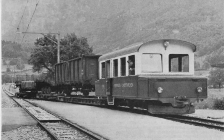
Abb. 1. Der Akku-Triebwagen TW 4 der MIB mit einem Rollwagen-Güterzug an der Abfahrtsstelle in Meiringen, die außerhalb des SBB-Bahnhofs liegt. Der Triebwagen ist dunkelblau/creme gestrichen, Dach und Fahrwerk sind grau. Der Schneepflug ist zusätzlich montiert.
