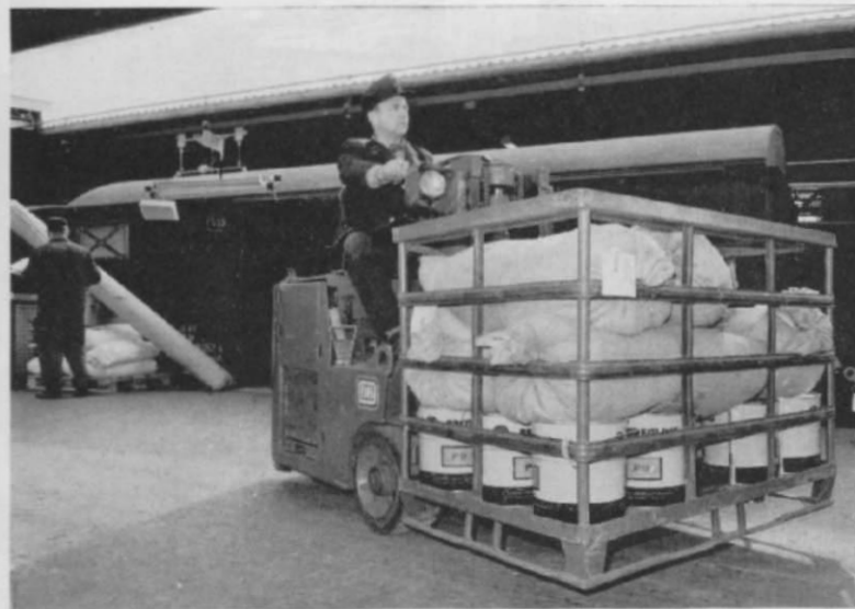
Abb. 10. Eine stabile Variante der Gitterbox-Palette (s. Abb. 11 u. 12).
