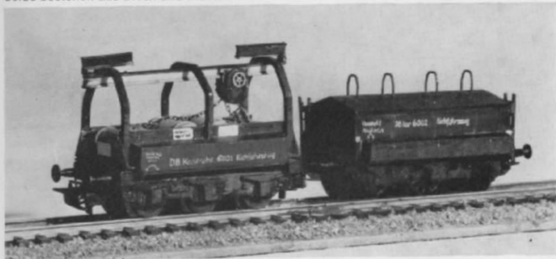
Abb. 4. Auch bei den Eichfahrzeugen wurden außer Federpuffern, Radsätzen und Kupplungen keine Fertigteile verwendet; beide bestehen aus Blech und Plastik.
