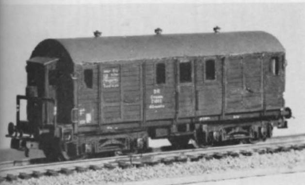
Abb. 1. Märklin-Drehgestelle und Federpuffer waren die einzigen Fertigteile beim Bau dieses Klima-Schneepflugs (nach Heft 12/71 u. 2/72); alles andere entstand aus Pappe und Plastik.
