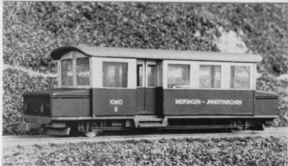
Abb. 6. Das Modell des Verfassers auf Probefahrt, mangels richtiger H0m-Gleise vorerst auf „verchmälerten“ Roco-H0-Gleisen. Der Schritzfzug entstand mit den kleinsten erhältlichen Aufreibebuchstaben (Letraset IL 1571, Schriftgröße 1,5 mm).
