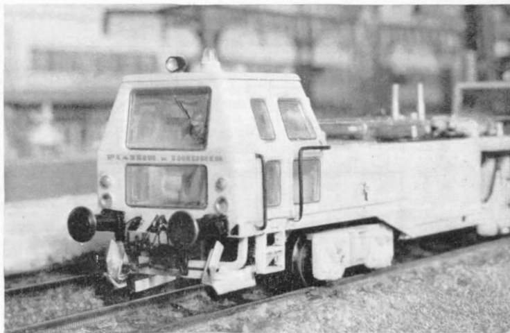
Abb. 14. Vorderseite des verfeinerten Modells: aufgesetzte Griffstangen, Rundum-Warnleuchte auf dem Dach, Meßwagen unter der Kabine, dreieckige Rahmenblende, Kupplung und Bremsschläuche. Die nicht besonders gut sichtbaren Meßrollen im Meßwagen sind übrigens Isolierbuchsen von N-Radsätzen!
