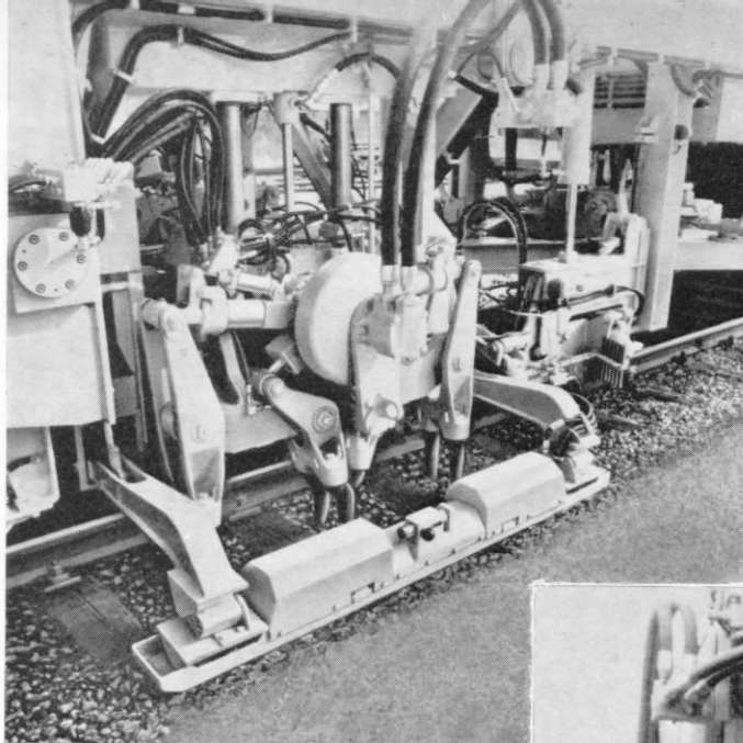
Abb. 10. Das Duomatic-Stoppaggregat. Der Vorkopfverdichter sorgt für seitliche Stabilität der Schwellenlage. Er ist jedoch eine Sonderausstattung, die nicht bei jeder Maschine eingebaut ist.
