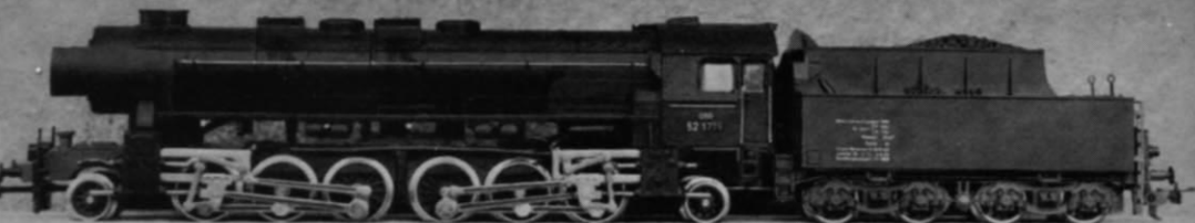
Abb. 1. Der „Entwurf Weitz I“ zur 3. Kriegslok: das aus Fleischmann- und Kleinbahn-Teilen entstandene Modell, das im Großen die Bezeichnung 1'CC 1'h4 G 68.20 gehabt hätte und damit in etwa dem Entwurf „Wiener Lokomotivfabrik I“ entspricht (s. S. 107 ff des auf S. 672 besprochenen Buches „Deutsche Kriegslokomotiven 1939–1945“).
