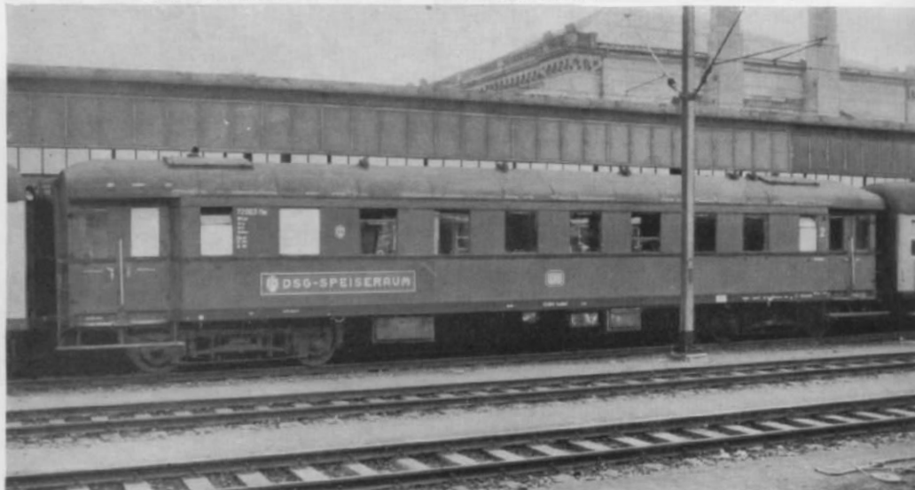
Abb. 14. Aus einem Probewagen der ehemaligen Bauart C4i-28a entstand bei der DB dieser Halbspeisewagen. Die „glatte“ Langträger-Partie ist bei diesem genieteten Wagen eine DB-Zutat. Wollte man die Waschbürsten schonen oder nur gerade Flächen für die Aufschriften schaffen?
