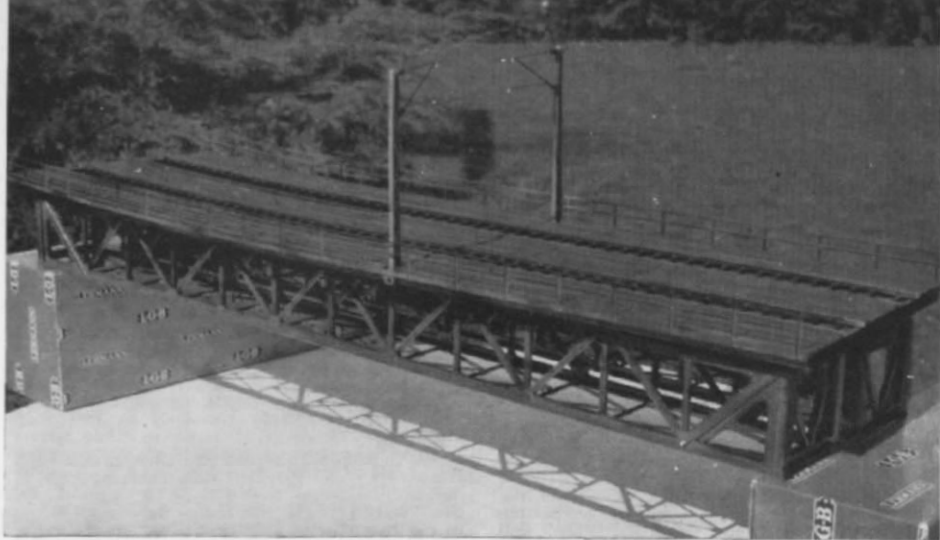
Abb. 12. Die Hauptträger dieser Fachwerkbrücke stammen aus insgesamt 16 (!) LGB-Brücken Nr. 5060 und wurden zu einem Fachwerkverband zusammengesetzt. Wind- und untere Endverbände bestehen aus Vollmer-Winkelpprofilen (2 x 2 mm), die Knotenbleche aus dünner Pappe. Als Brückenplatte dient 8 mm-Sperrholz bzw. im Gehsteigbereich 3 mm-Sperrholz, das zum Anlöten des Geländers (aus 2 x 2 mm-Messingprofilen) mit einem Messing-U-Profil eingesäumt wurde. Der Bohlenbelag besteht aus gebeizten Holzleisten 4 x 2 mm; das Riffelblech zwischen den Schienen fehlt noch.
