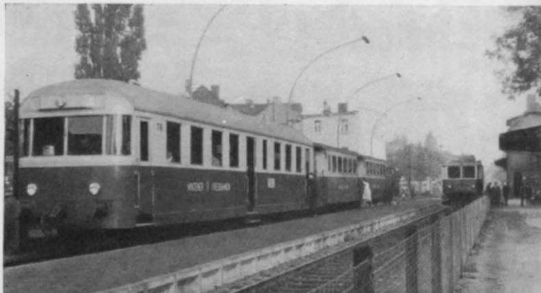
Abb. 17. Aus einem C4i-35a entstand dieser Triebwagen T 6 der Mindener Kreisbahn.
