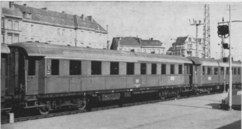
Abb. 6. Das ist die längere Variante mit vier Abteilen der höheren Klasse: der ABYse 622 (ehemals BC 4i-33a).
