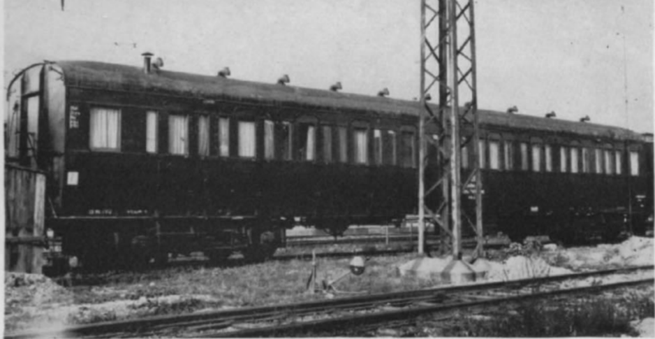
Abb. 7. Der Abteilwagen „englischer“ Bauart vom Typ BC 4i-33g, hier die Abteilseite. Diesem interessanten und eigenwillig/elegant wirkenden Wagen ist auch unsere heutige Bauzeichnung (S. 602/603) „gewidmet“.
