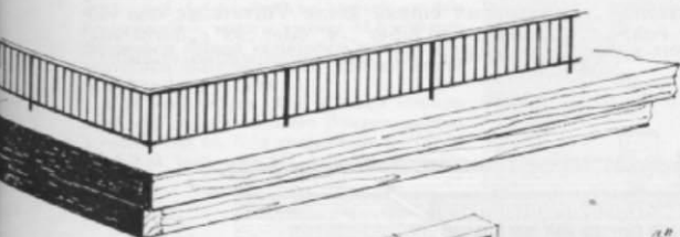
Abb. 21. Anfertigung der viereckigen ornamentartigen Verblendung der Abb. 16/18. Aus 2 mm-Sperrholz wird ein Vierkantröhr zusammengeklebt, von dem jeweils – in einer passenden Gehrlade bzw. einer ähnlichen Hilfsvorrichtung – 6 mm „dicke“ Scheiben abgesägt werden. Der Anstrich erfolgt mit betongrauer Plakafarbe.
