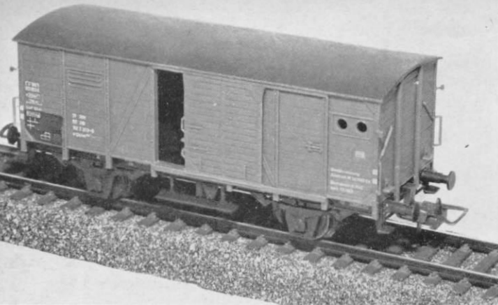
H0 Abb. 224. Der G 10 (ehemals „Kassel“) als feindetailliertes H0-Modell von Röwa mit dünnen Schiebetüren, feinen Signalhaltern u. a. m.
