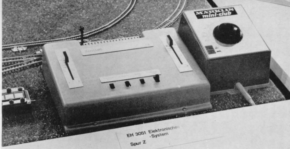
Z-H0 Abb. 197. Das Blockstellen-Bedienungsgerät mit zwei Schiebereglern (zur Geschwindigkeitsregelung in zwei Blockstrecken – z. B. Strecken- und Bahnhofsbereich) und vier Fahrtrichtungsschaltern – hier demonstriert an der Märklin-Z-Bahn, wobei der Z-Trafo nur zur Stromversorgung dient.
