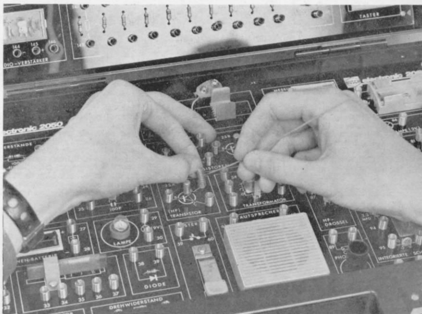
Abb. 26 u. 27. Bei dem Elektronik-Experimentierkasten erfolgt die Verdrahtung über Spiralfedern, die einem jeden Bauteil-Anschluß zugeordnet sind; sie brauchen nur umgelegt zu werden, der Verbindungsdraht wird zwischen die Spiralen gesteckt und nach Loslassen der Feder ist der Kontakt hergestellt.
