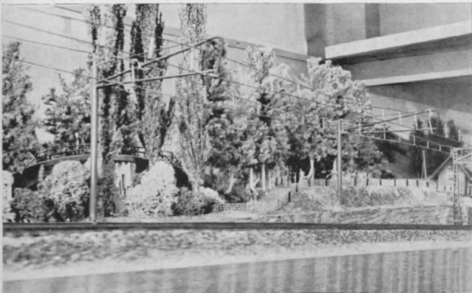
Abb. 4. Die selbstgebaute Oberleitungsmasten mit Doppelauslegern an der zweigleisigen Hauptstrecke. Da direkt vor der Strecke ein schmaler Gang verläuft, schien Herrn Buck das normalerweise übliche Aufstellen von jeweils zwei Masten – wegen der Gefahr des Umreißen – nicht ratsam!
