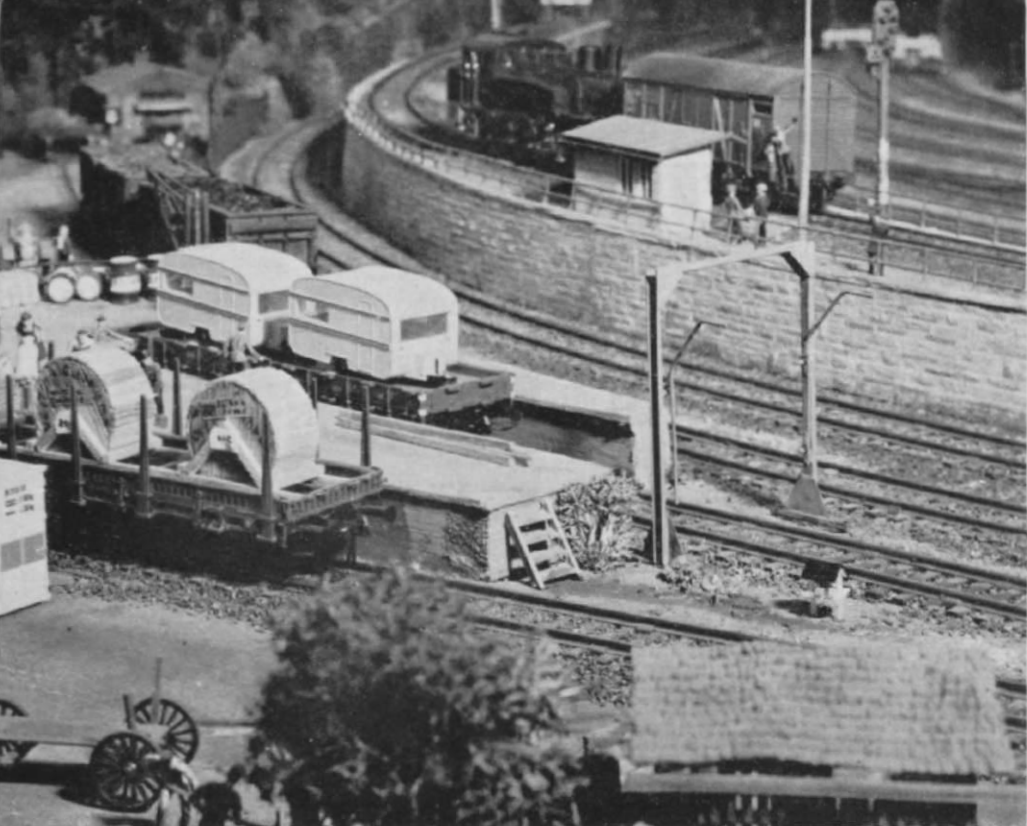
Abb. 7. Ein selbstgebautes einfaches Lademaß auf der REPA-Bahn des Herrn Ertmer, Paderborn (s. auch Heft 10/73, S. 662). Es besteht aus U-Profilen und Lehren aus dünnem Stahldraht.
