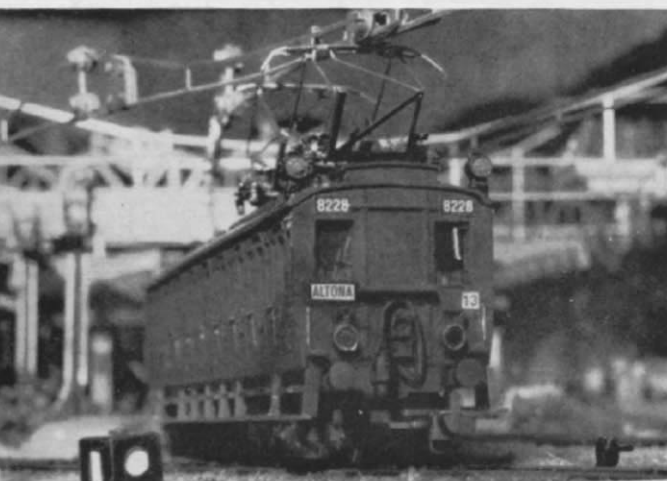
Abb. 5 u. 6. Das Modell des älteren Hamburger S-Bahn-Triebwagens entstand aus zwei Lilliput-Abteilwagen. Alle überstehenden Teile wie Wagenboden, Trittbretter und Puffer wurden an je einem Ende der Wagen so abgetrennt, daß beide Wagen möglichst dicht aneinander auf einem gemeinsamen Drehgestell gelagert werden konnten. Der Motor (aus einer alten Märklin-V 200) befindet sich über dem vorderen Drehgestell. Die Stromzuführung erfolgt vorbildgetreu über zwei Pantographen aus der Oberleitung. Die jeweiligen Stirnselten wurden nach Original-Abbildungen gestaltet, die Richtungsschilder aus Original-Fahrplänen ausgeschnitten. Als Zugverlängerung baute Herr Ziebarth noch eine zweite, antriebslose Garnitur.
