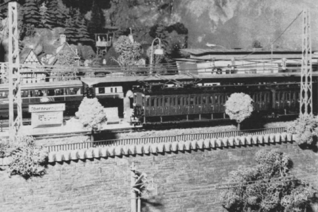
Abb. 5 u. 6. Das Modell des älteren Hamburger S-Bahn-Triebwagens entstand aus zwei Lilliput-Abteilwagen. Alle überstehenden Teile wie Wagenboden, Trittbretter und Puffer wurden an je einem Ende der Wagen so abgetrennt, daß beide Wagen möglichst dicht aneinander auf einem gemeinsamen Drehgestell gelagert werden konnten. Der Motor (aus einer alten Märklin-V 200) befindet sich über dem vorderen Drehgestell. Die Stromzuführung erfolgt vorbildgetreu über zwei Pantographen aus der Oberleitung. Die jeweiligen Stirnselten wurden nach Original-Abbildungen gestaltet, die Richtungsschilder aus Original-Fahrplänen ausgeschnitten. Als Zugverlängerung baute Herr Ziebarth noch eine zweite, antriebslose Garnitur.
