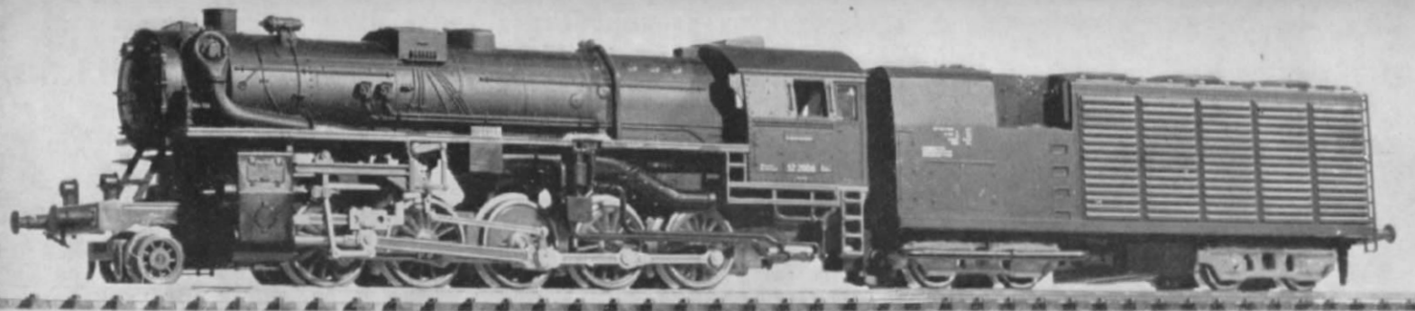
Abb. 4. Das imposante 30,5 cm lange H0-Modell der Kondens-52 aus der Bahndampfperspektive; Wiedergabe in ca. \frac{1}{3} Originalgröße. — Abb. 5. Blick auf den Triebtender mit dem Ballastgewicht im abgenommenen Gehäuse. Die schwarzen Kunststoffringe dienen einerseits zur leichteren Montage bzw. Demontage der Trieb-Drehgestelle (Ringe auseinanderpreizen und aus- bzw. einklipsen), andererseits zu deren drehzapfenlosen Aufhängung im Rahmen.
