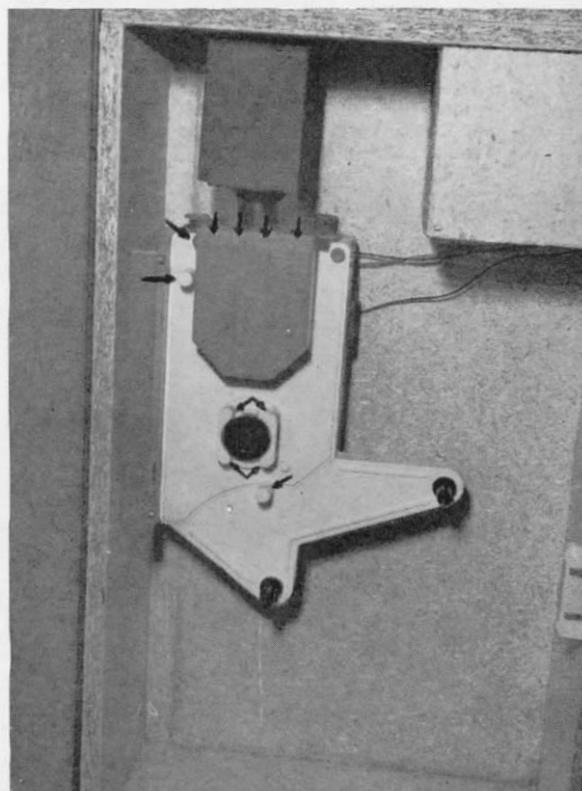
Abb. 2. Projektor und Projektorkasten (aus Spanplatten). Der Papp-Tubus dient zur Vermeidung von Streulicht-Einfall durch die Projektor-Lampe. Die Pfeile bezeichnen die mit der Feile zu bearbeitenden Teile (s. Haupttext).
