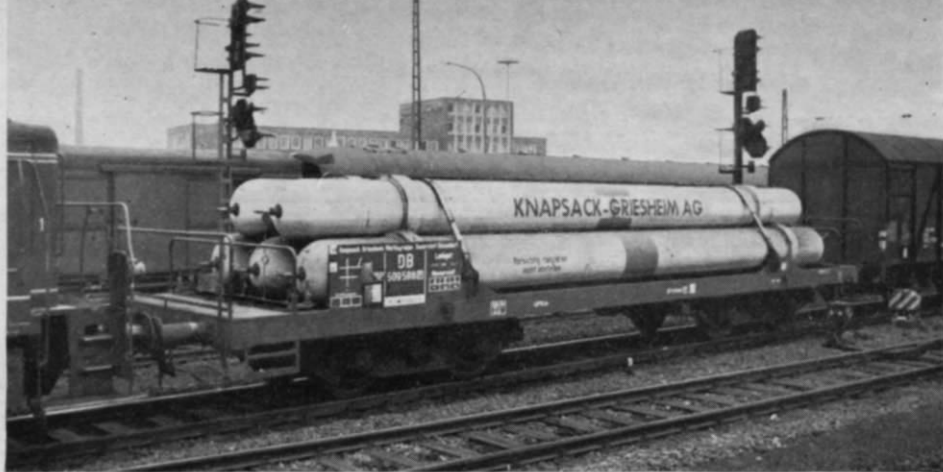
Abb. 50. Röhre oder wie hier Tanks mit empfindlicher Oberfläche werden mit Gurten niedergebunden.
