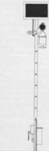
Abb. 4. Ein Schutzhalt-Signal mit beweglicher Scheibe und Umlenk-Mechanismus in \frac{1}{4} H0-Größe (1:87). Die Höhe des Mastes kann je nach den örtlichen Gegebenheiten variieren. Alle Zeichnungen dieses Artikels: WiWeW.
