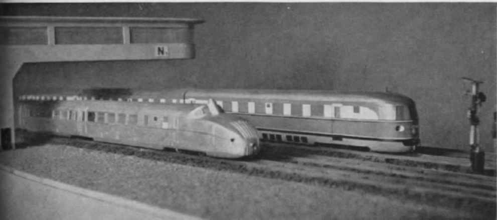
Abb. 13. Schienenschnellverkehr „damals“ im Modell (Spur 0): links der Kruckenberg-SVT 137, rechts ein dreiteiliger Schnelltriebwagen der Reichsbahn-Bauart, ein Nachfolgetyp des weltweit bekannten „Fliegenden Hamburgers“.
