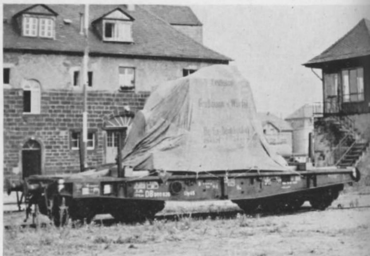
Abb. 19. Was sich unter der Wagendecke verbirgt, ist zwar nicht genau zu erkennen; es handelt sich aber offenbar um ein Ladegut mit ungleichmäßiger Auflagefläche (erkenntlich an dem Untergestell), das außerdem wegen seiner Empfindlichkeit durch eine Wagendecke geschützt werden muß. Die Decke ist zusätzlich V-förmig niedergebunden.
