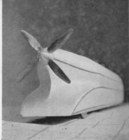
▲ Abb. 10. Die Heckpartie des Windkanal-Modells der Abb. 8.
