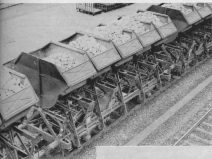
Abb. 11. Ein „bis zum geht nicht mehr“ mit Koks beladener O-Wagen der CFL. Die bis an die Seitenwand-Kanten reichende und auf diesen aufliegende Ladung widerspricht den Vorschriften der DB!
