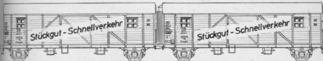
Abb. 2. Diese Leig-Einheiten (= Leichter Güterzug) zur schnellen Stückgutbeförderung — zusammengesetzt aus zwei kurzgekuppelten G-Wagen, z. B. des Typs „Leipzig“ — mit der charakteristischen diagonalen Aufschrift gibt es bei der DB heute nicht mehr. Schade, daß Röwa das geplante H0-Modell einer solchen Leig-Einheit wieder zurückgestellt hat. Als Anregung für Umbauten zeigen wir hier eine Leig-Einheit in N-Größe (s. dazu auch MIBA 12/68).
