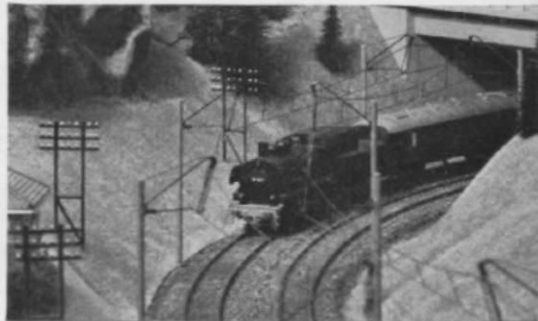
Abb. 21. Zum Abschluß noch ein Beispiel (das inzwischen korrigiert worden ist), wie es – zumindest bei einer Bahn der Jetztzeit – nicht sein darf: die Oberleitung schließt die Freileitung neben dem Gleis aus!
