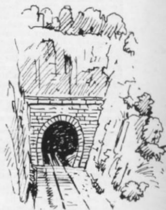
▲ Abb. 4. Beispiel für ein in einem Einschnitt gelegenes Tunnelportal, dargestellt von Pit-Peg. (Ein modernes Gegenstück zu diesem gemauerten Portal zeigt Abb. 10).
