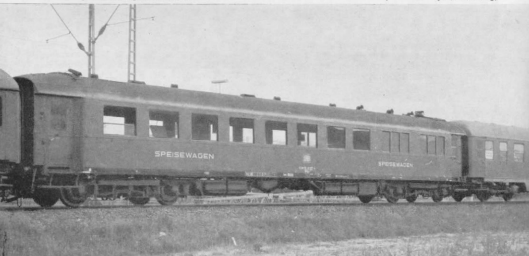
Abb. 12. Ein Speisewagen (WR), passend zur 35er-Bauart, hier in einen Reisebüro-Sonderzug (erkennlich an dem kleinen Schild am folgenden Liegewagen) eingestellt. Derartige Vorkriegs-Speisewagen sind auch heute noch häufig in D-Zügen zu entdecken. (Foto: H. Hoyer, Hamburg)
