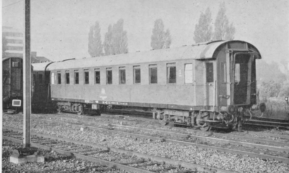
Abb. 4. Das ist der ehemalige C 4ü-28 (Abteilseite), noch in recht originalem Zustand. Man beachte die Lüftungsklappen in den Fenstern, die auf der Gangseite nicht üblich waren. (Foto: H. Hoyer, Hamburg)
