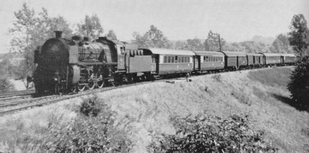
Abb. 24. 1964 bei Bad Waldsee aufgenommen: die 18 630 vor einer Garnitur aus Vorkriegs-Eilzugwagen mit Schürze, einem 4-achsigen Umbauwagen, Gepäckwagen ohne Zugführeraufbau und Vorkriegs-Schnellzugwagen. (Foto: Dr. R. Brüning, Bruchköbel)
