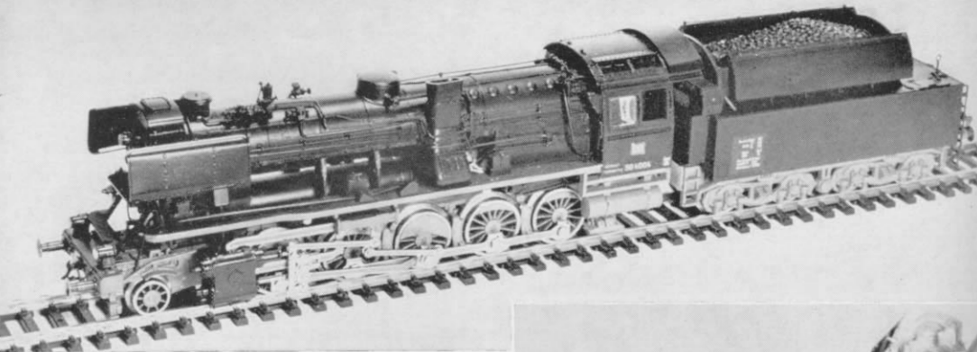
Abb. 4. Bei der Normalausführung der 50 10 sind einige Einzelheiten unterhalb des Umlaufs (z. B. Rohrleitungen, Steuerung) gegenüber der Superausführung vereinfacht (s. Abb. 1 u. 6 sowie Haupttext).
