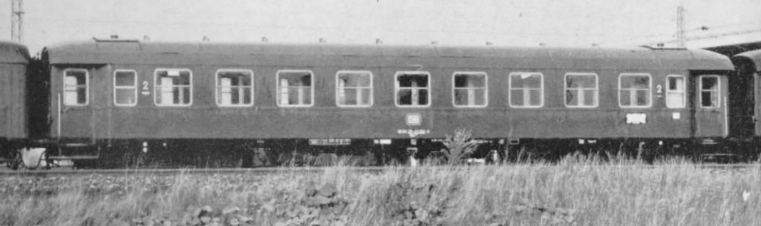
Abb. 11. Ein Sonderling im Wagenpark der DB: Dieser einstige C 4ü-35 wurde mit modernen UIC-Übersetzerfenstern versehen. Zwar stehen diese auch u. E. dem Wagen nicht so recht „zu Gesicht“; aber über Geschmack läßt sich bekanntlich (nicht) streiten. Auf jeden Fall: Das seinerzeitige Liliput-Modell des 1./2. Klasse-Eilzugwagens mit Übersetzerfenstern (MIBA 5/68, S. 215) kann also „guten Gewissens“ im normalen Zugbetrieb eingesetzt werden. (Foto: H. Hoyer, Hamburg)
