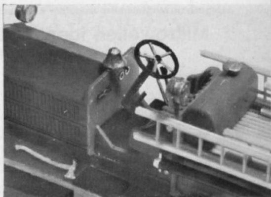
Abb. 16. Der Fahrersitz des Jordan-Feuerwehrwagens (Abb. 14) mit Lenkrad, Glocke, Armaturen, Schalthebel etc. Die Hacke ist natürlich gleichfalls ein Extrateil.
