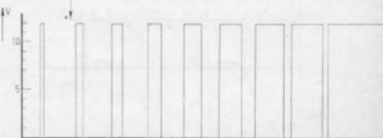
Abb. 10. Dto. bei Impulsbreiten-Modulation. In den Abb. 7–9 ist deutlich die gerade im Langsamfahrbereich starke Änderung der Amplitude zu erkennen, während diese bei der Impulsbreiten-Modulation über den ganzen Bereich konstant bleibt. (Die Diagramme der Abb. 7–10 stellte uns freundlicherweise die Fa. Hilektrouw, Zaandam, zur Verfügung.)
