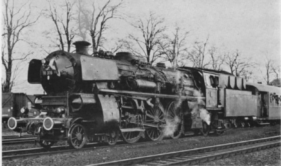
Abb. 26. Die 18 316 erhielt 1965 den Kessel der ausgemusterten 18 319, der aufgrund veränderter Einströmrohre eine etwas längere Rauchkammer hatte – wodurch die Lok (unserem Gefühl nach) irgendwie „kopflastig“ wirkt. Die Aufnahme entstand bei einer Sonderfahrt im Jahre 1968 („50 Jahre badische IVh“) – ein Jahr, bevor die 18 316 endgültig ausgemustert wurde. (Foto: W. Klein, Weinheim)
