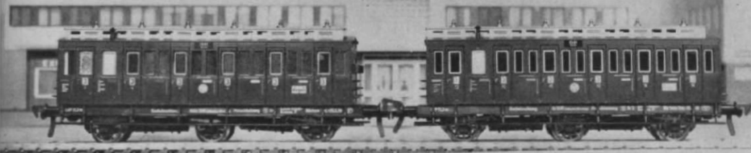
Abb. 3. Auch den H0-Abteilwagen von Fleischmann haben wir einer „Operation“ unterzogen: rechts der Original-Wagen mit Holzrahmen an allen Fenstern, daneben das gleiche Modell mit den schmalen Fenstern ohne Holzrahmen. Zusätzlich wurden beim linken Wagen noch die Bremsklötze an den Rädern der Mittelachse entfernt (vgl. Haupttext).
