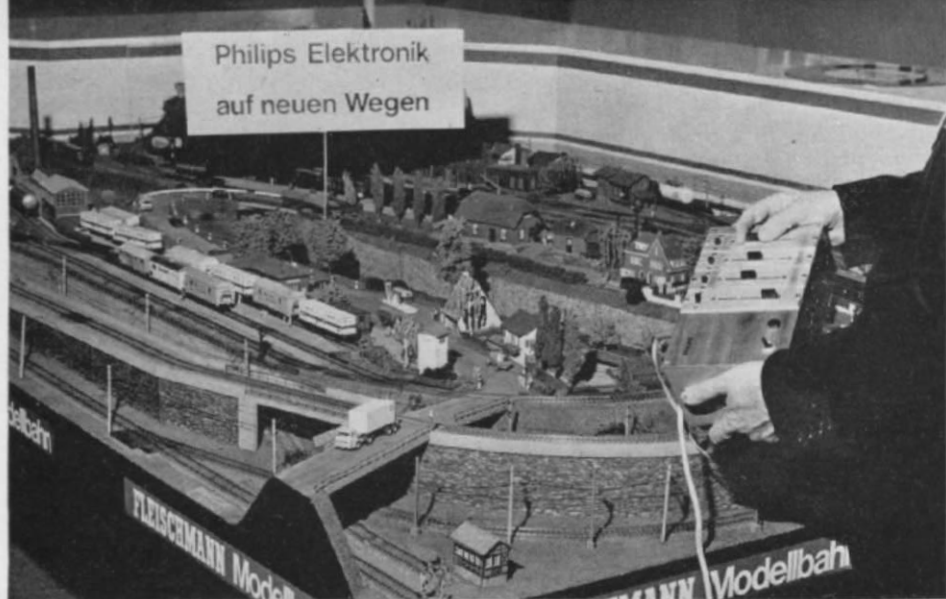
H0 Abb. 197. Auf dieser Anlage demonstrierte Philips das neue Mehrzug-System. Das Steuergerät war allerdings nur ein Handmuster, jedoch werden auch bei der endgültigen Ausführung Schiebereglер zur Geschwindigkeitssteuerung eingebaut sein.
