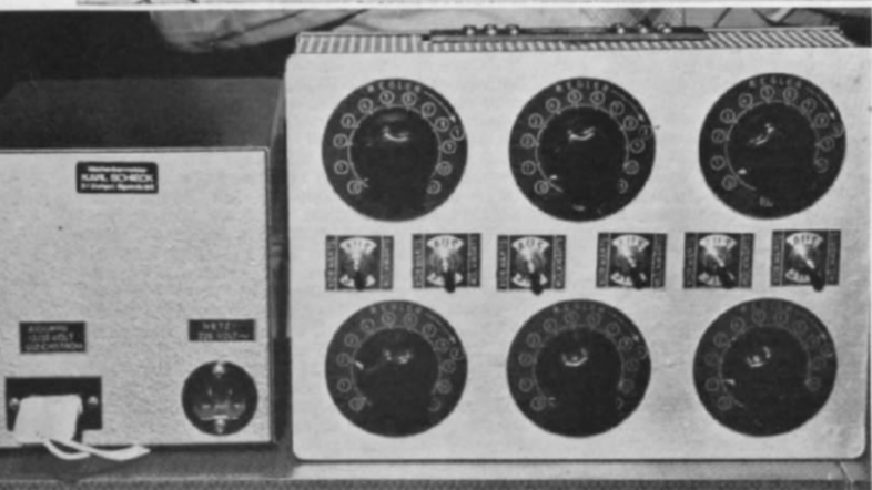
O ▽ Abb. 241. Der 120 VA-Fahrtrafo mit Anzeige-Instrumenten und dem Umschalter 12 V/18 V; links der Fahrtrichtungsschalter mit Verriegelung und der Netzschalter, daneben der Regelknopf.
