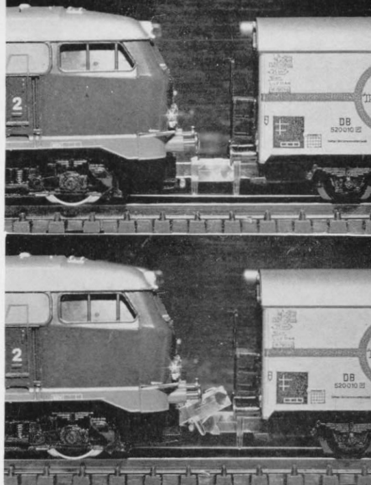
N Abb. 12 u. 13. Die erläuterten Kupplungsstellungen in der Praxis bei dem N-Modell der BR 217.
