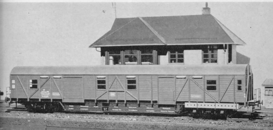
0 Abb. 142 u. 143. Die Wände der MD4i-Wagen (unten der Hilfsgerätewagen, links der Packwagen) bestehen aus 1,5 mm starken, gravierten Kunststoffplatten mit Nemec-Profilen, das Dach aus einer 0,3 mm-Kunststoffplatte.
