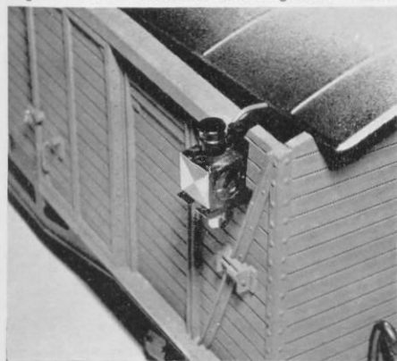
Ilm Abb. 116. So kann das (beleuchtbare) Zugschluß-Signal bei einem gedeckten Güterwagen zwischen Dach und Wand eingesetzt werden.
