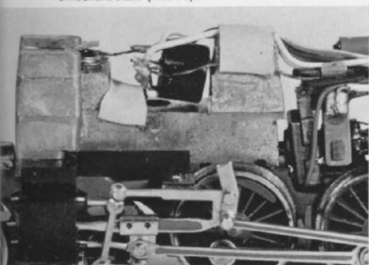
Abb. 3. Die Aussparung auf dem Bleigewicht, die zur Aufnahme des Gleichrichters dient, wird nach den im Haupttext angegebenen Maßen herausgefeilt. Das Lämpchen für die Stirnbeleuchtung verbleibt in seiner ursprünglichen Halterung.
