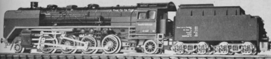
Abb. 2. Gesamtansicht der Arnold-BR 41, hier die Heizersseite. Hinter dem Windleitblech sitzt (auf dem Umlauf über dem Steuerungsträger) der Ein- bzw. Ausschalter für den Rauchentwickler. Das (wohl aus Fabrikationsvereinfachung gleich große) Gegengewicht der Treibachse läßt sich mit einem entsprechenden Stück dünnen Kartons vergrößern.
