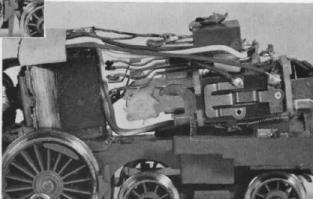
Abb. 4. Hier sieht man die unmittelbar hinter der Auflage des Bleigewichtes beginnende Ausfräsung des Fahrgestells, die die notwendige Schräglage des Motors ermöglicht. Direkt hinter dieser Auflage ist das ursprüngliche Bleigewicht abzusägen (vgl. Abb. 3).
