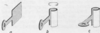
Abb. 10 zeigt in vergrößerter Darstellung die Formgebung von Teil 3, dessen Fläche zu einem feinen Röhrchen gebogen werden muß (um eine Stecknadel). Anschließend muß die Öse noch um 90° geschränkt werden.
