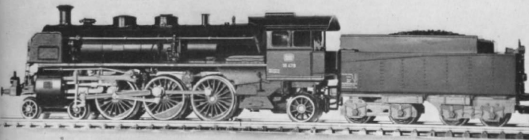
Abb. 1. Diese Gesamtansicht des – serienmäßig mit Rauchentwickler ausgestatteten – S 3/6-Modells zeigt den relativ engen Abstand zwischen Lok und Tender; gut zu erkennen ist die typische Doppel-Z-Kontur des Aschkastens. Darüber sieht man die – leider motorbedingte – Ausbuchtung im Stehkessel. Die Pumpen sind freistehend am Umlauf ange setzt.
