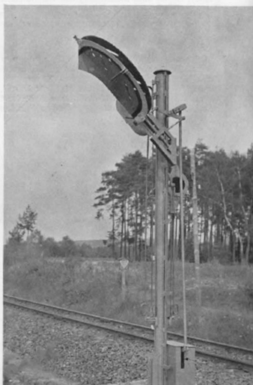
Abb. 9. Der Zusammenbau der beiden Signalscheiben mit dem Teil 3, dem Hebel 4 und der
