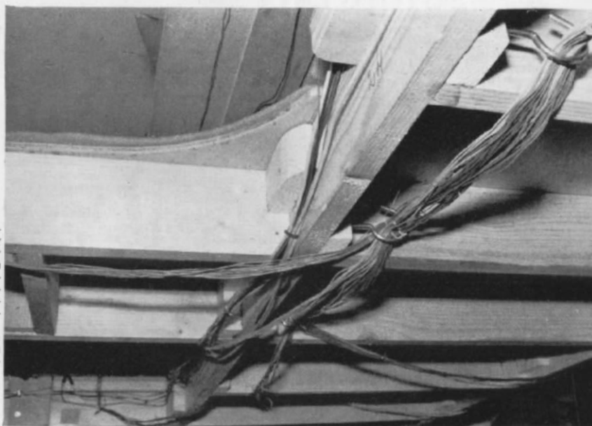
Abb. 6. Die Kabelführung unter der Anlage. Die in der Bildmitte nach oben verlaufenden 4 dicken Kabel sind ummantelte Kupferdrähte zur Fahrstromversorgung; aus ihnen wird ca. alle 2 m Strom in die Schienen eingespeist.
