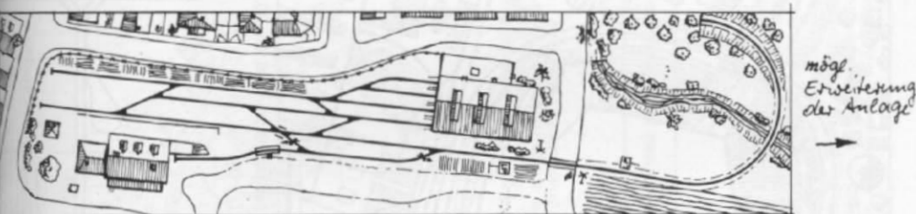
Abb. 2. Gleisplan für eine Schmalspur- oder Normalspur-Anlage nach dem Vorbild des Bf. Heddesheim. Zeichnungsmaßstab 1:33 für H0. Die Strecke verschwindet hinter einer Biegung und führt in die untere Ebene, wo sich einige Abstellgleise befinden.
