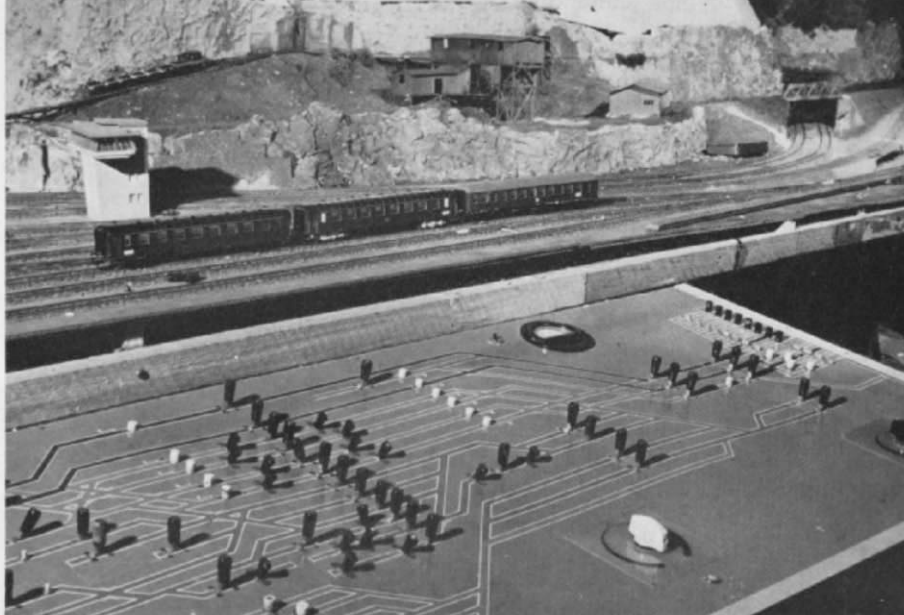
Abb. 2. Eines der nunmehr fertiggestellten und angeschlossenen Stellpulte ohne Rückmeldung der Weichen- und Signalstellungen. Fahrstraßenwahl durch Umlegen des Start- und Ziel-Kellogschalters. Befinden sich daneben noch Kippschalter, so kann das Gleis zwei- oder dreifach abgeschaltet werden, bei Endgleisen, Schuppen etc. also drei Loks hintereinander. Drei Fahrtrichtungsregler können wahlweise auf die Streckengleise geschaltet werden, während der Fahrstrom von den Weichen (Postrelais) jeweils bis zur Bahnhofsmitte geleitet wird. Umschalten der Weichen in der Gleisharte (unterer Bildrand) mittels Druckknöpfen. — Im Hintergrund Bf. „Unter-Elmenthal-Ost“ sowie das Bergwerk mit der Egger-Lorenbahn im „Rohgelände“, das ... Abb. 3. ... inzwischen fertiggestellt und mit Islandmoos „aufgeforstet“ wurde.
