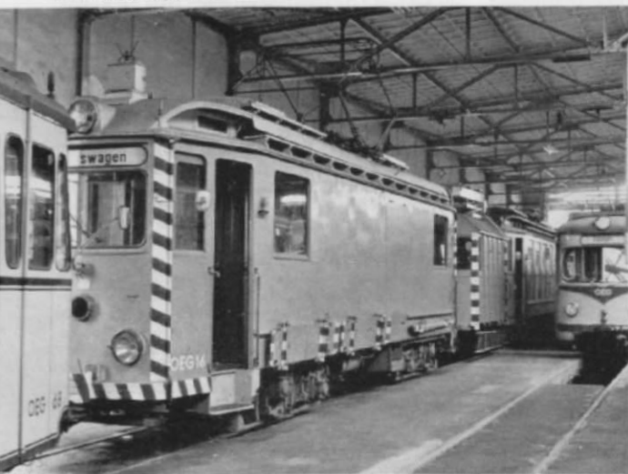
Abb. 28. Der Triebwagen Nr. 16 wurde als Hilfswagen umgebaut. Die seitlichen Fenster sind teilweise verschlossen und außerdem wurden an den Seitenwänden Werkzeuge und Geräte aufgehängt. Anstrich: orange (RAL 2000).
