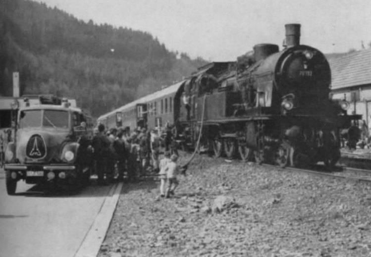
Abb. 1. Wasserfassen — ganz primitiv! — Da an vielen „bedieselten“ Strecken schon keine Wasserkräne und -türme mehr existieren, muß bei Sonderfahrten gelegentlich die Feuerwehr als „Wasserspender“ einspringen — ein vielleicht willkommener Anlaß, auch im Modell mal ein Feuerwehr-Fahrzeug „bahngerecht“ einzusetzen, und sei es nur zu fotografischen Zwecken!
