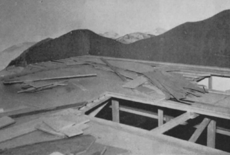
Abb. 7—10. Diese vier Abbildungen verdeutlichen den schrittweisen Aufbau der Bw-Partie mit der Nebenbahn-Schleife. Auf den Dämmplatten werden mit Sperrholz-Unterbau die Gleistrassen verlegt; gleichzeitig nimmt das aus aufeinandergeschichteten Dämmplatten bestehende Gelände Konturen an. Auf Abb. 10 (unten rechts) sind die Dämmplatten bereits mit einem Gemisch aus Kaltleim, Sägemehl und Zeitungspapier „verputzt“; die dunklen Flecken sind die im Haupttext erwähnten echten Felsstücke.
