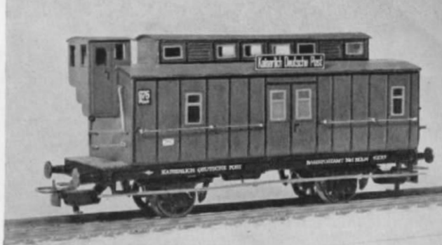
► Abb. 2. Angewandter Prägeband-Baukniff: H0-Modell des Postwagens aus MIBA 14/68. Die sehr exakten Beschriftungen sind fotografische Verkleinerungen (s. MIBA 2/67).
