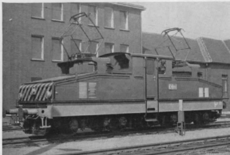
Abb. 8. Nochmals die EH 81, die 1971 modernisiert wurde. Die zwei Drehgestelle werden von vier Tatzlager-Motoren zu je 145 kW angetrieben. Die Lok verfügt über eine 320 V-Batterie und kann damit auch auf Gleisen verkehren, die nicht mit Oberleitung überspannt sind.
