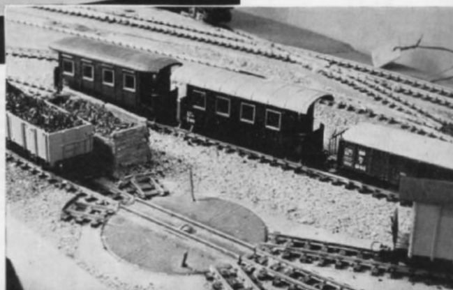
Abb. 6. Die Lokomotiv-Drehscheibe im Bf. „Laufenmühle“ wurde nach einem Vorbild der Murtalbahn gebaut; sie ist handbetrieben und dient gleichzeitig als Gleisschalter für die Drehscheibengleise rechts vorn. Baumaterial: Pertinax mit aufgeklebten Schienenprofilen, Konstrukteur: Manfred Schneider. – Im Hintergrund ist die Vollspur-/Schmalspur-Kreuzung zu erkennen.
