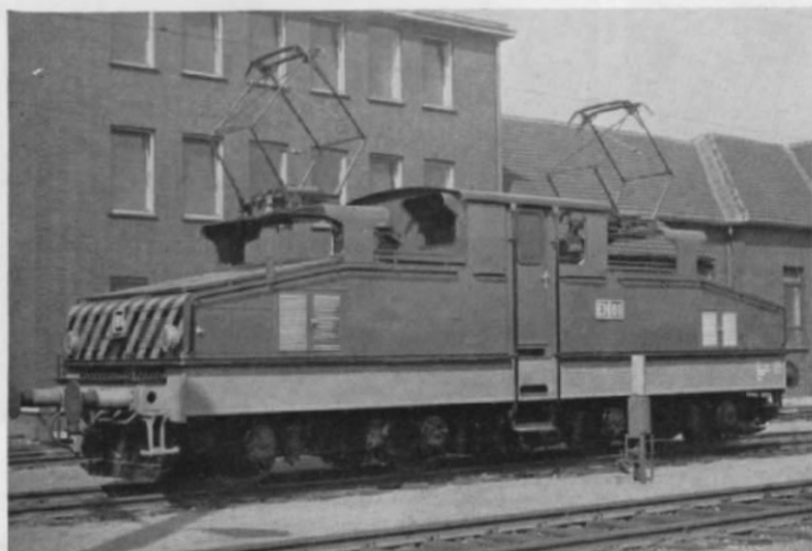
Abb. 8. Nochmals die E 81, die 1971 modernisiert wurde. Die zwei Drehgestelle werden von vier Tatzlager-Motoren zu je 145 kW angetrieben. Die Lok verfügt über eine 320 V-Batterie und kann damit auch auf Gleisen verkehren, die nicht mit Oberleitung überspannt sind.
