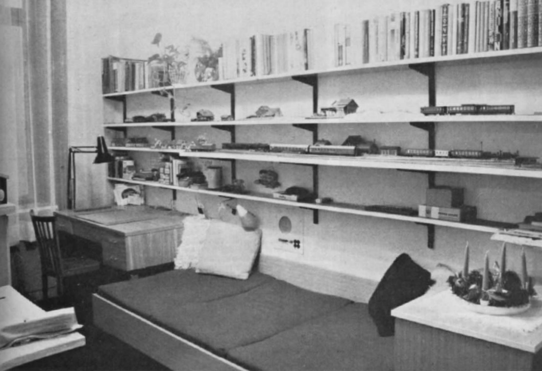
Abb. 2. Blick auf die Regalwand mit den beiden Anlagenbrettern. Links am Fenster wird das Verbindungsstück zur Hauptanlage eingehängt. — Das unterste Regalbrett ist nur 15 cm breit und nimmt Bastelmaterial etc. auf; darüber liegt das Brett mit dem Bahnhof „Laufenmühle“, das links wegen des darunter befindlichen Schreibtisches wieder schmaler (15 cm) wird. Anschließend das Brett mit den Bahnhöfen „Zindelstein“ und „Schwarzenbach“ und darüber wieder ein Bücherbrett. Die beiden „Eisenbahnbretter“ sind durch den einhängbaren Tunnelberg der Abb. 3 u. 4 verbunden.
