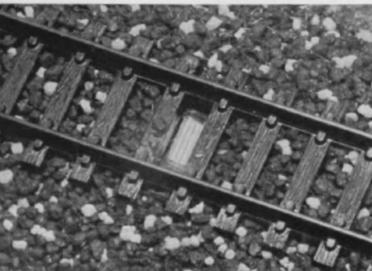
Abb. 1. Nur bei wirklich genauem Hinsehen und günstiger Beleuchtung kann man den unter dem Gleis zwischen zwei Schwellen „versteckten“ Fotowiderstand entdecken. Aus normalem Betrachtungsabstand ist er praktisch „unsichtbar“. (Abb. in ca. doppelter Originalgröße!)
