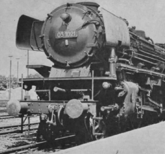
Abb. 5. Genaugenommen sitzt bei einer 03 10 das Schutzrohr des Innenzylinders genau zwischen zwei Trittstufen. Wer es ebenfalls genau nimmt, kneife beim M+F-Teil das Rohr weg, feile das durchgehende Trittbrett ein und setze einen Metallstift als Schutzrohr-Attrappe ein. Der Schornstein-Aufsatz der M+F-03 10 ist übrigens vorbildgetreu; der Schlot dieser „03 1021“ stellt eine weitere Variante dar. (Foto: K. D. Holzborn, Essen)
