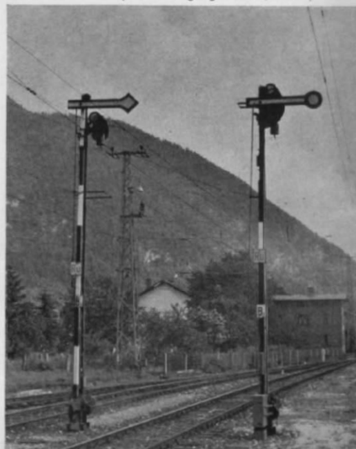
Abb. 2. Es muß nicht immer ein bayerischer Flügel sein: ein Ruhe-Halt-Signal mit Einheitsflügel und abweichender Blendenform — in friedlicher Zweisamkeit mit einem „Bajuwaren“ — im Bahnhof Bad Reichenhall. (Foto: Wolfgang Fischer, Berlin)
