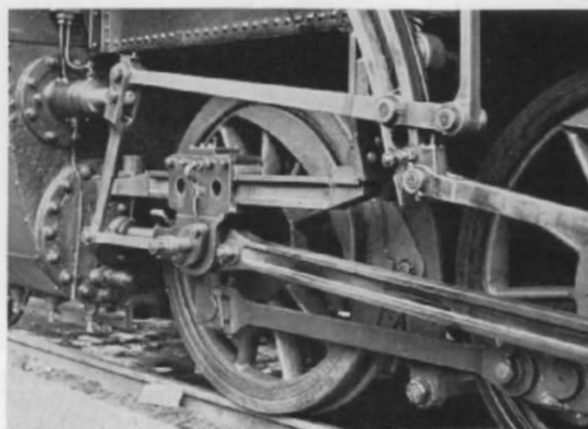
Abb. 9. Wer sich noch genauer über das Triebwerk und die äußere Steuerung des Vorbilds informieren möchte, wird durch dieses Foto sicher zufriedengestellt. (Foto: Horst Reinsberg, Lollar)
