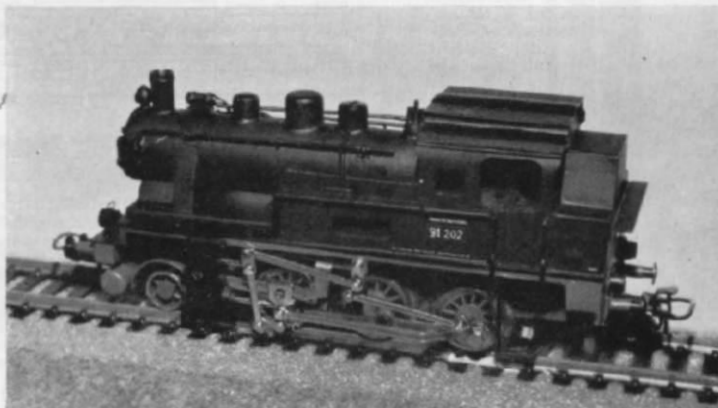
Abb. 1. Der fertig gespritzten und beschrifteten „91 202“ ist ihre T3-Abstammung kaum noch anzusehen. Gerade die sonst bei ELNA-Lokomotiven nicht vorgesehenen Wasserkästen auf dem Umlauf eignen sich in diesem Fall bestens zur Tarnung des Getriebes.
