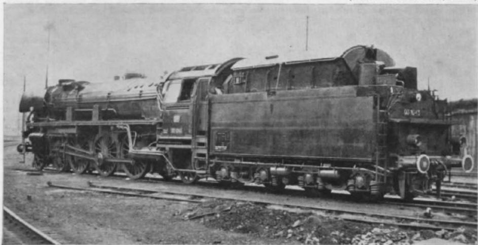
Abb. 6. Das Vorbild für den neuen M+F-Tender der Abb. 7: eine 03 10 mit einer Spezialvariante des Tenders 2'2' T 34, hier mit hochgeklappter Kohlekasten-Abdeckung. (Wegen des relativ hohen Fleischmann-Motors kommt eine funktionsfähige Nachbildung dieser Abdeckung beim M+F-Bausatz leider nicht in Frage). Das Aggregat hinter dem Kohlekasten ist der Antrieb der Kohlevorschub-Einrichtung. (Foto: K. D. Holzborn, Essen)
