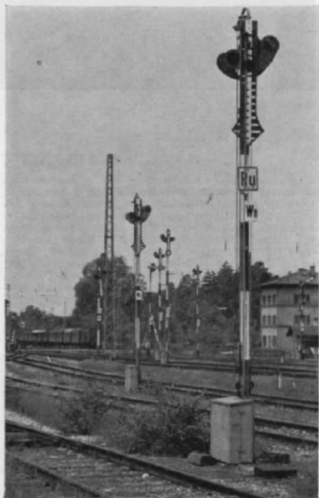
Abb. 1. Mehrere typische Ruhe-Halt-Signale bayerischer Bauart in der ebenso typischen Stellung Hp Ru: Der durchbrochene, gefeilte Flügel zeigt senkrecht nach unten; auf den zugehörigen Gleisen darf rangiert werden. Man beachte das Ru-Schild (roter Rand und rote Schrift auf weißem Feld) und die Form des Antriebskastens. Ganz rechts ist noch ein Ruhe-Halt-Signal in Hp 1-Stellung zu erkennen, das dem davonfahrenden Personenzug „Freie Fahrt“ erteilt hat. (Foto: Rolf Ertmer, Paderborn)
