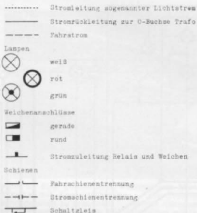
Abb. 2. Zeichenerklärung für die in Abb. 1-7 verwendeten Symbole. Besonders wichtig für das Verständnis der Abb. 7: der Unterschied zwischen Fahr-schienen- und Stromschienen-Trennung!
