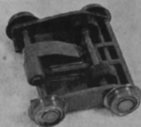
Abb. 2. Der auf 37 mm-Spur laufende „Druckwagen“, der mit seinen zwei Druckrollen die Längsträger der Bühne anhebt (s. a. Abb. 6).
