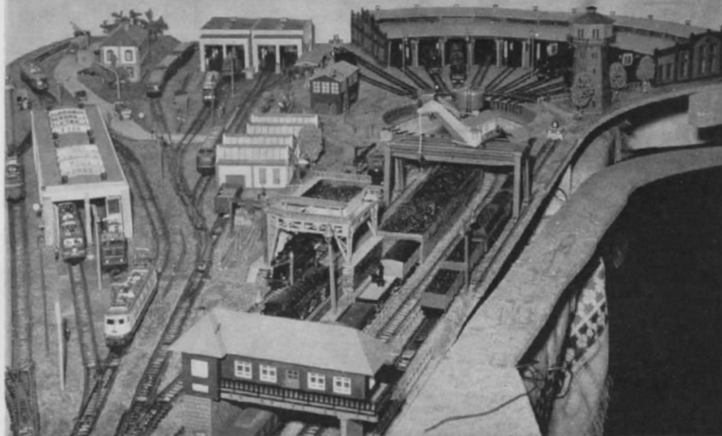
Abb. 1. Das Bw aus der Richtung des Personenbahnhofs betrachtet. Auf dieser Aufnahme kann man deutlich die Trennung der Behandlungsanlage für die einzelnen Traktionsarten erkennen: links im Mittelgrund die Durchfahr-Halle für die Elloks, in der Mitte hinten die Tankstelle und den Schuppen für die Dieselloks und im rechten Bildteil (von vorne nach hinten) die Beköhlung mit Wiegebunker und Kran, Drehscheibe und Dampflok-Schuppen. Auf der noch nicht bebauten Trasse (rechts nach unten führend) werden später noch Streckengleise geführt (vergl. Abb. 2).
