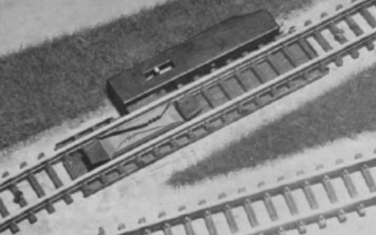
Z Abb. 163. „Selbstverständlich“ gibt es auch schon ein Entkupplungs-Gleisstück, dessen Elektromagneten oder von Hand betätigt werden kann.
