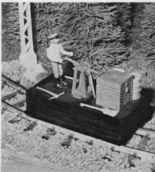
Ilm Abb. 114. In dieser endgültigen Ausführung (umgestaltet und verbessert) kann die Draisine jetzt nicht mehr am Dauerentkuppler hängen bleiben.
