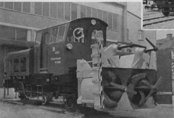
Abb. 4 u. 5. Die Beilhack-Bahnschneeschleuder HB 8 B. Auf den Wurfrollwellen sitzen zwei Vorschneidepropeller zum Abfräsen des Schnees; darüber zwei zusätzliche Propeller zur Bearbeitung großer Schneehöhen. (Maximale Räumhöhe: ca. 3,50 m.) Der um 180° drehbare Aufbau macht die Bahnschneeschleuder unabhängig von Drehscheiben und Gleisdreiecken. (Werkfoto Beilhack GmbH, Rosenheim)
