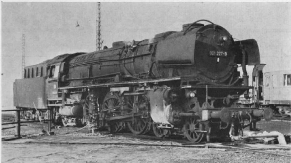
Abb. 15 u. 16. Ein Vergleich der Lokführerseiten zeigt, daß hier zwischen einer 001 (Abb. 15) und einer 012 (Abb. 16) kaum Unterschiede bestehen. Das Anstellventil der Luftpumpe sitzt bei der 012 unterhalb des Dampfdomes und ist mit diesem durch ein Rohr verbunden.
