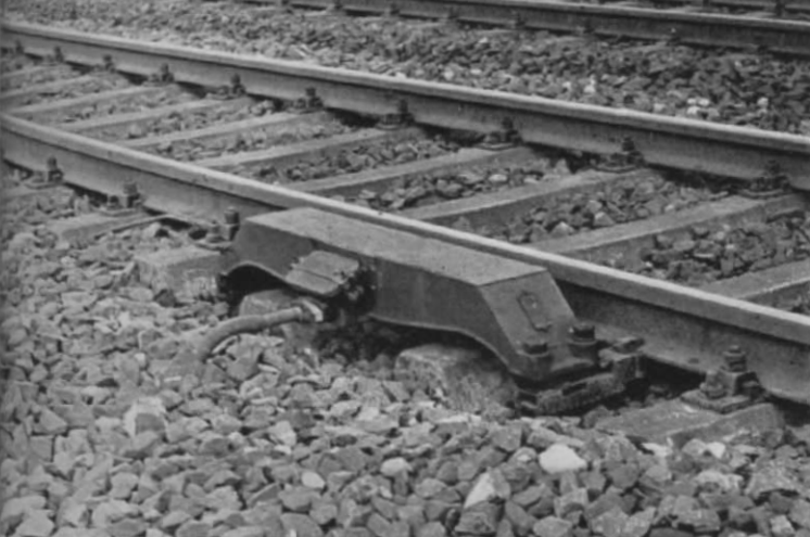
Abb. 5. Ein Indusi-Gleismagnet als Vorlage für den Nachbau im Kleinen; er reicht etwa bis zur Schienenoberkante und „überbrückt“ zwei Schwellen. Das Kabel führt zum zugehörigen Signal; zeigt dies „Freie Fahrt“, schließt ein Kontakt den Schwingkreis kurz und macht ihn damit unwirksam.
