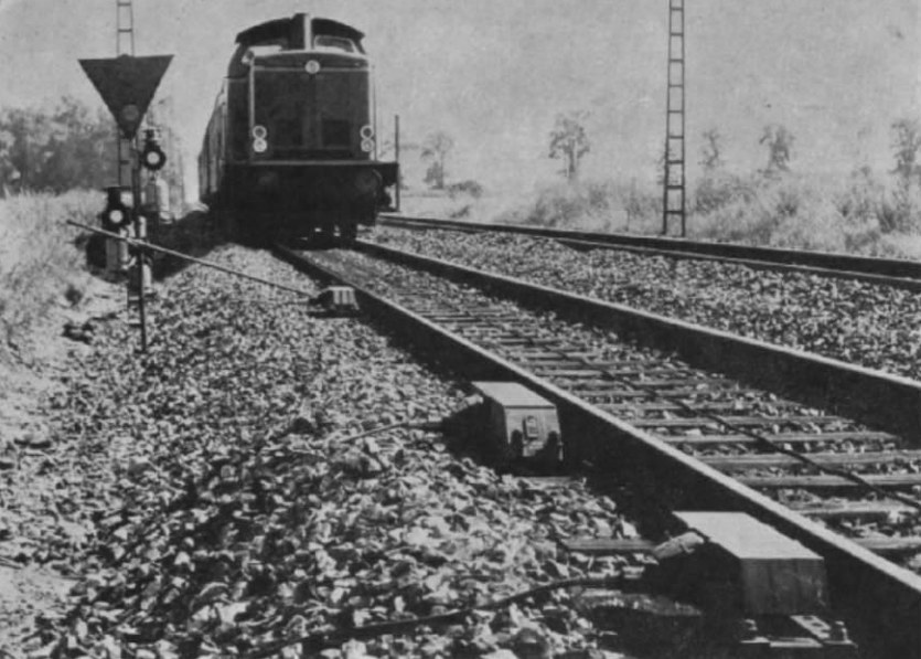
Abb. 1. Induktive Zugsicherung an einer Langsamfahrstelle, an der gleich drei Gleismagnete die Geschwindigkeit des vorbeifahrenden Zuges überwachen. Der erste schaltet ein Zeitglied ein, das nach Ablauf der entsprechenden Zeit den zweiten, den eigentlichen Beeinflussungsmagneten, unwirksam schaltet. Erreicht die Lok bei zu hoher Geschwindigkeit den zweiten Magneten, noch bevor er durch das Zeitglied abgeschaltet wird, tritt Zwangsbremsung ein. Der dritte Magnet dient nur zum Abschalten der Anlage.
