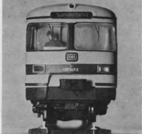
Abb. 1. Hinter den mit Scheibenwischer-Imitationen versehenen Frontfenstern ist ein Triebwagenführer zu erkennen (s. auch Abb. 3). Die saubere Nachbildung der Scharfenberg-Kupplung läßt sich gegen eine Röwa-Tauschkupplung auswechseln, was das Aneinanderkuppeln mehrerer Einheiten ermöglicht.
