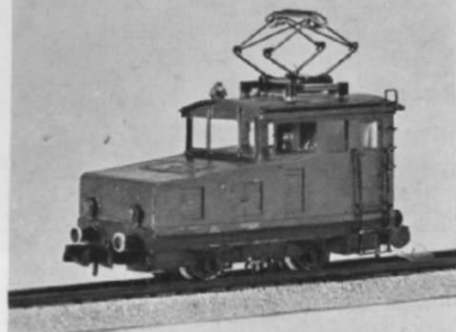
Abb. 5. Die Elok LAG 4 (die „Großmutter“ der heutigen E69) basiert ebenfalls auf dem Mini-trix-T3-Fahrgestell, bei dem in diesem Fall nur die Räder der mittleren Achse abgezogen worden sind. Das Gehäuse entstand aus 0,3 mm Kupferblech, die Achslager sind von einem G-Wagen, Druckluftkessel, Lüftergitter und sonstige Kleinteile bestehen teilweise aus Aluminium bzw. Aluminium-Folie.
