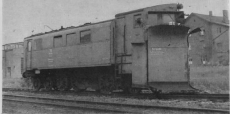
Abb. 6. Falls jemand der Nachbau der bay EP 3/6 (Heft 12/71) daneben geht – nicht wegwerfen! Entsprechend diesem Vorbild zu einem Klima-Schneepflug ummodelln! Obri- gens: Hinter dem ersten Kuppelrad sitzt an Stelle der ausgebauten Blind- welle noch eine wei- tere kleine Pflug- schar! (Foto: Dr. Rolf Brü- ning, Bruchköbel)
