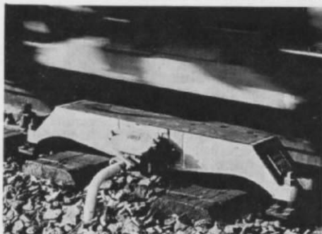
Abb. 2 u. 3. Indusi-Magnete an einem Triebfahrzeug (oben) und am Gleis im Moment des Überfahrens.
