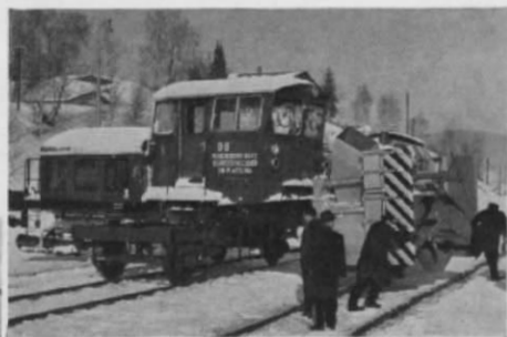
Abb. 4 u. 5. Die Beilhack-Bahnschneeschleuder HB 8 B. Auf den Wurfrollwellen sitzen zwei Vorschneidepropeller zum Abfräsen des Schnees; darüber zwei zusätzliche Propeller zur Bearbeitung großer Schneehöhen. (Maximale Räumhöhe: ca. 3,50 m.) Der um 180° drehbare Aufbau macht die Bahnschneeschleuder unabhängig von Drehscheiben und Gleisdreiecken. (Werkfoto Beilhack GmbH, Rosenheim)
