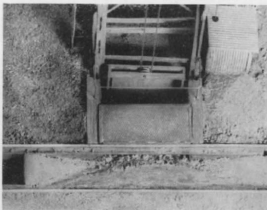
Abb. 4. Der Förderkorb, dessen Rahmen aus Nemec-Profilen besteht, in Ruhestellung. Die Riffelblech-Abdeckung ist mit 1 x 1 mm-Winkelprofil eingefäßt, das Schutzgitter ebenfalls aus Neusilberdraht angefertigt.
