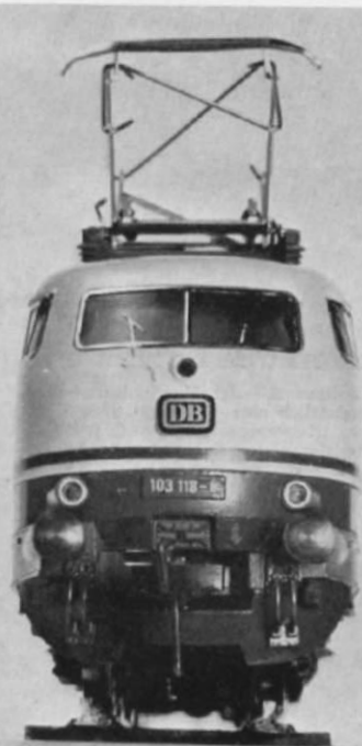
Abb. 2. Die Stirnansicht zeigt weitere Details wie die exakt passende Verglasung mit (auf dem Gehäuse fortgesetzten) Scheibenwischer-Nachbildungen, Schlauchanschlüsse unter den Puffern usw.
