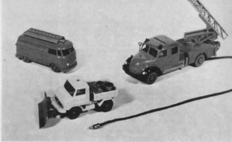
Abb. 1. Vorn ein für den Einbau eines gelben Birnchens vorbereiteter Unimog mit der deutlich sichtbaren Dachbohrung. Dahinter ein Leiterwagen mit eingebauten Birnchen. Beide Fahrzeuge sind noch nicht bemalt; der kleine Feuerwehr-Einsatzwagen ist noch im ursprünglichen Zustand. Weitere Wagen, die für einen Umbau geeignet sind, findet man im Wiking-Prospekt.
