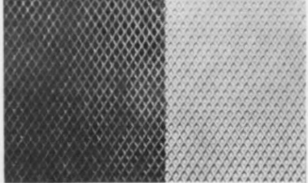
Abb. 1. Die feine Prägung des Günther-Riffelblechs bleibt nach der Brünierung erhalten, wie dieses Mustersstück deutlich erkennen läßt.
