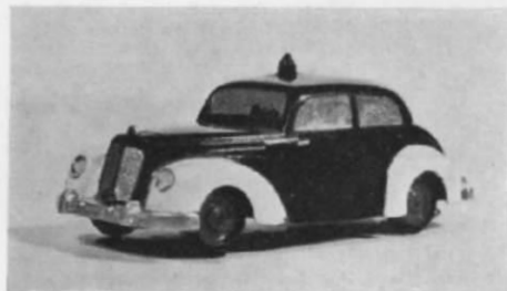
Abb. 3. Ein fertiger Streifenwagen älteren Typs. Die Bemalung erfolgt mit Plastik-Farben. Die Kotflügel werden weiß, Lampen und Stoßstangen silber, Reifen schwarz gestrichen. Der sichtbare Glaskolben des Birnchens wird mit blauem Lack betupft, den man aber nicht ganz aufrühren sollte, damit das Blau glasiert bleibt.
