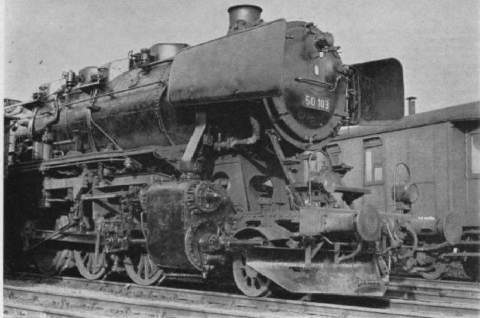
Abb. 17. Im Bw Euskirchen entdeckte OSTRA an einer Lok der BR 50 einen Vorsteck-Schneerräumer, der Anlaß für unsere Kleinbastelei auf den Seiten 798/799 war und dessen Modellanfertigung im gegebenen Fall auch für Sie eine kurzweilige Feierabend-Bastelei bedeuten wird.
