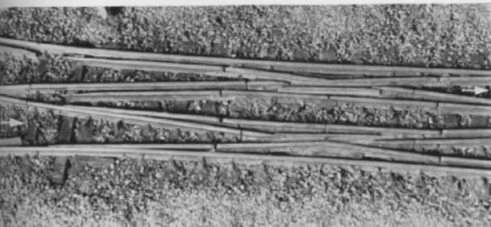
Abb. 9. Die erwähnte DKw mit stellbaren Radlenkern, die ein sicheres Befahren in gerader Richtung garantieren, hier „geradeaus“ von links unten nach rechts oben (s. Pfeile).
