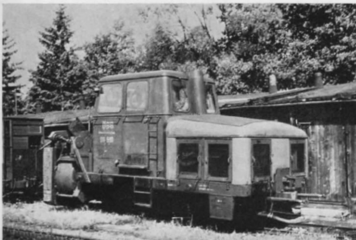
▲ Abb. 15. Schmalspuriger Klima-Schneepflug „98.505“ der ÖBB in Gmünd/Niederösterreich auf der Waldviertelbahn.
