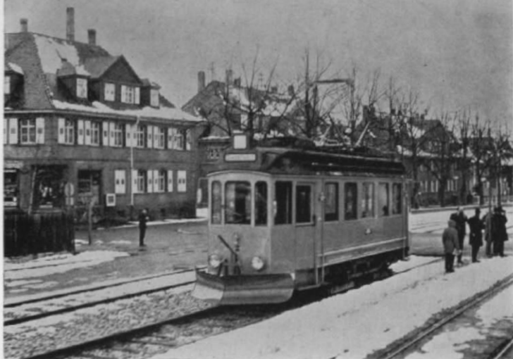
Abb. 11. Arbeits-triebwagen der normalspurigen Alb-talbahn in Karlsruhe. Der Schneepflug kann von Hand abgesenkt werden.
