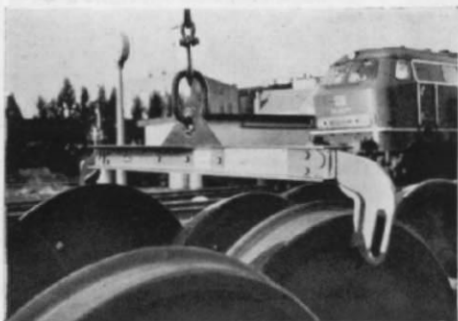
Abb. 11. Zeichnerisch nicht dargestellt: das Hebeschirr — hier kurz vor dem Anheben eines Radsatzes. Wenn der Kranführer das Geschirr etwas weiter herunterläßt, können die Klammern von einem Arbeiter mit einer Schwenkbewegung nach oben weggehoben werden.
