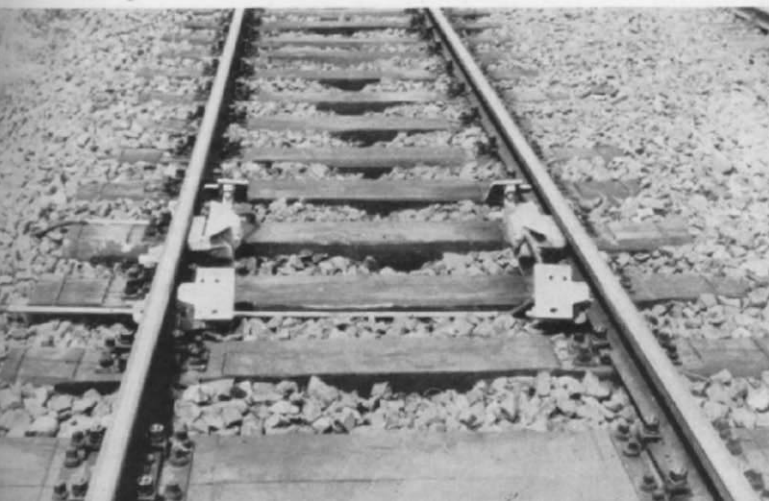
Abb. 3. Der Modellbahn abgeschauf? — Gleiskontakte für eine Achszählvorrichtung.
