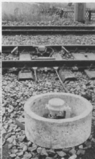
Abb. 3. Der Modellbahn abgeschauf? — Gleiskontakte für eine Achszählvorrichtung.
