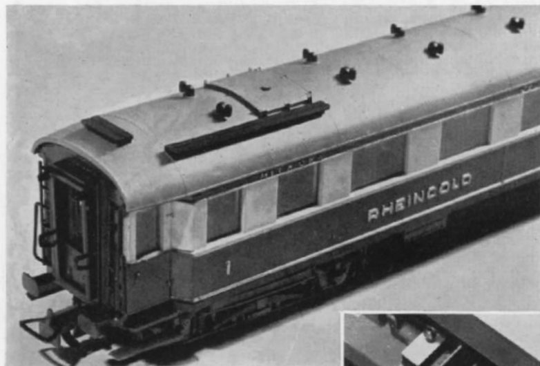
Abb. 2. Die Dachpartie ist einer näheren Betrachtung wert. Laufstege und Lüfter sind extra aufgesetzt; die sauberen Nietreihen verhelfen der Dachpartie ebenfalls zu einer wohlthuenden Unterscheidung von den heute üblichen glatten Dächern – kurz gesagt: die Dachpartie wirkt interessanter.
