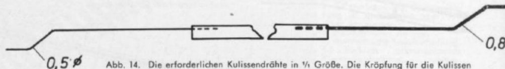
Abb. 14. Die erforderlichen Kulissendrähne in \frac{1}{4} Größe. Die Kröpfung für die Kulissen kann also direkt von der Zeichnung abgenommen werden.
