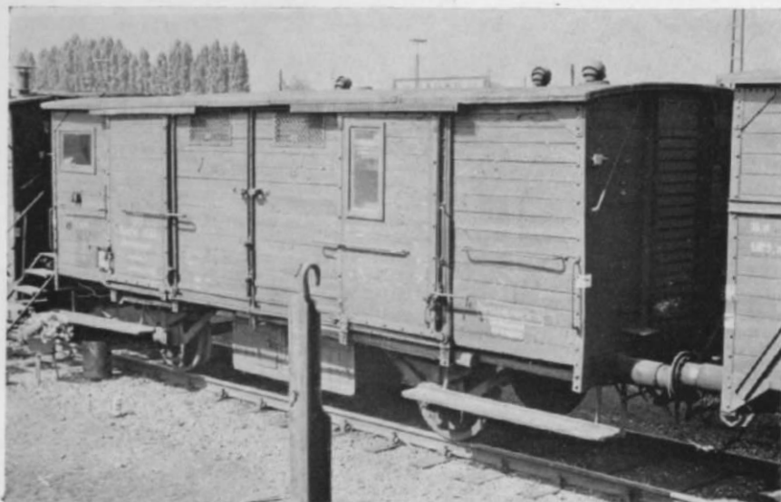
Abb. 1. Das Vorbild unserer heutigen Bauzeichnung, das noch heute in einem Bauzug Dienst tut! An der Stirnseite sind die typischen Lüfterjalousien noch vorhanden, wenn sie auch von innen verschlossen sind.
