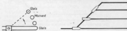
Abb. 10 u. 11. Der Schalter ist um zwei Endkontakte für die Gleisversorgung erweitert worden.
