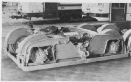
Abb. 14 u. 15. Für diejenigen, die es ganz genau wissen wollen: ein Düwag-Motordrehgestell, einmal von links und einmal von rechts wegen der unterschiedlichen Seitenansichten. Bei den nichtangetriebenen Drehgestellen entfallen Motor und Getriebe. Auf Abb. 15 kann man ein antriebsloses gerade noch am linken Bildrand erkennen.
