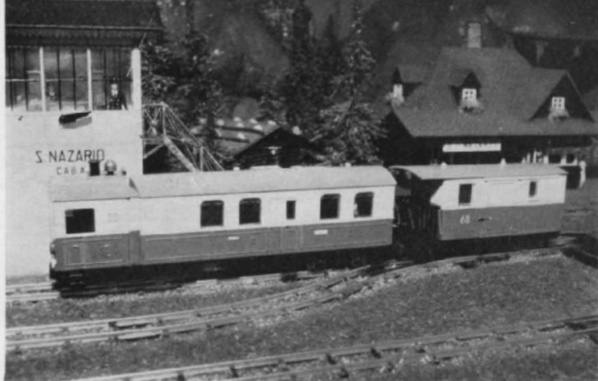
Abb. 2. Der Dampftriebwagen kann dank der ihm verpaßten Kupplung nunmehr wenigstens 1-2 Wagen ziehen – wenigstens auf der Schmalspur-Anlage des Verfassers.
