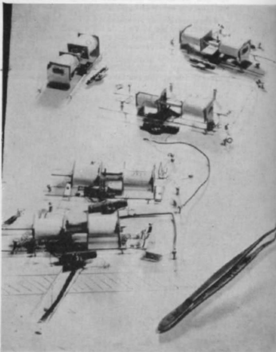
Abb. 1 u. 2. Die Einfahrtweichen des Abstellbahnhofs auf einer 22 mm starken Tischlersperrholzplatte sowie die Unterseite.
