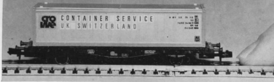
Abb. 65 u. 66. Der Tragwagen Lbs 598 mit zwei der 3 neuen 40'-Containern; außerdem gibt es noch zwei 20'-Container-Nachbildungen mit unterschiedlichen Aufschriften, die allesamt abnehmbar sind.
