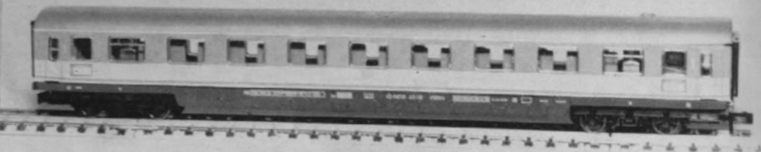
Abb. 58 u. 59. Weitere maßstäblich „Lange“ in N: der moderne 1. Kl.-Schnellzugwagen Avümz 111 in Pop-Farbgebung kieselgrau mit orangefarbenem Band (Bild oben) sowie der gleiche Wagentyp in Blau, beide mit Inneneinrichtung und gelbem 1. Klasse-Kennstreifen an den Dachunterkanten.
