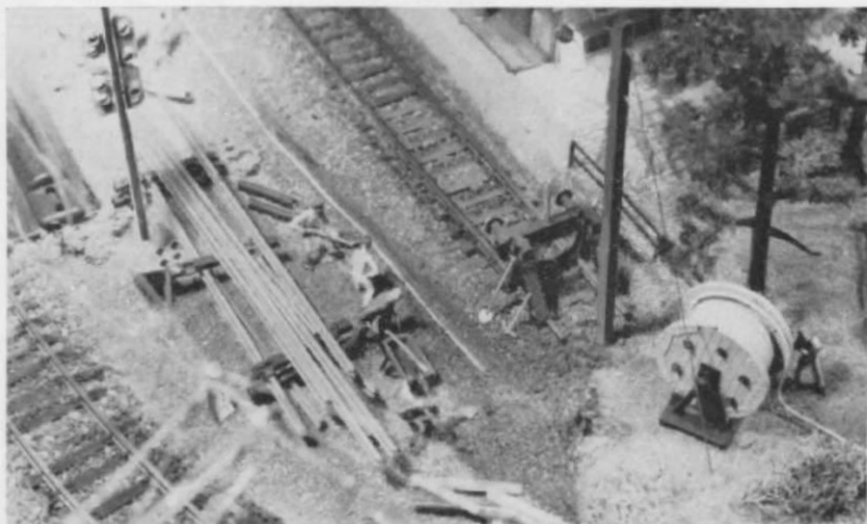
Abb. 33. Kabelleger am Werk (im Bf. Breitenstein). Das neu aufgestellte Gruppenausfahrtsignal ist noch nicht in Betrieb. Das weiß/schwarze Kreuz stellt das ÖBB-Signal K 106 dar (= Schneeräumarbeit einstellen).
