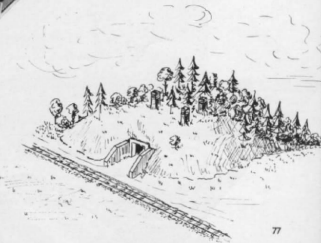
Abb. 4. Der Hügel mit Gleisanschluß – das Munitionsdepot im Innern eines bereits vorhandenen Hügels. Zwischen den Bäumen und Sträuchern sind einige Be- und Entlüftungsrohre anzubringen, deren Äußeres etwas groß geratenen, mit Abdeckplatten versehenen Wohnhausschornsteinen gleicht.
