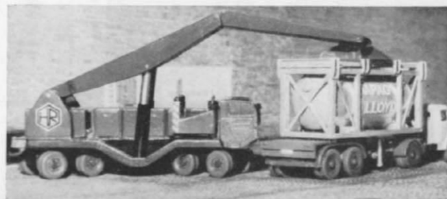
Abb. 4. Hier wird gerade von dem Umschlaggerät ein Tank-Container (Selbstbau nach Fotos) von einem Container-Sattelschlepper abgehoben. Bei solchen Arbeiten ist ein vorderes Abstützen nicht erforderlich.
