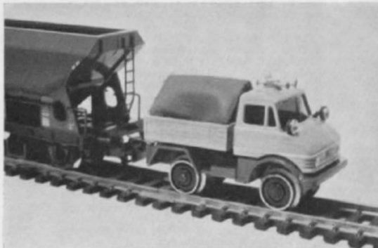
Abb. 1. Der umgebaute Matchbox-Unimog beim Einsatz als Schienen-Fahrzeug. Deutlich sind die zusätzlich angebrachten Signalleuchten und das Signalhorn zu erkennen. Die Kuppelung besteht aus einem Drahtbügel, der in beidseitig unter den Bordwänden angebrachten Laschen befestigt ist . . .
