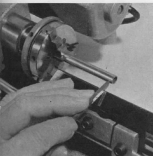
Abb. 3. Werkstücke, bei denen es nicht so sehr auf Genauigkeit ankommt (Zierteile usw.) können am einfachsten mit Handstählen gedreht (oder auch „gedrechelt“) werden. Dabei wird der Drehstuhl auf der Handauflage aufgelegt und mit beiden Händen geführt.
