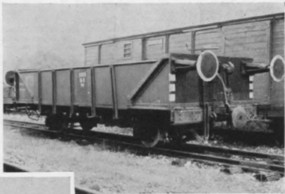
Abb. 1. Zwischenwagen der SWEG (750-mm-Spurstrecke Möckmühl – Dörzbach). Man beachte die Abstützung der Puffer mittels Winkelisen auf den Wagenboden. Die Seitenwände aus Blech sind rotbraun gestrichen, die Stirnwände dagegen schwarz.
