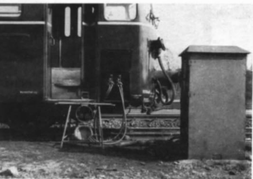
Abb. 9. Vom Gleichrichterwagen läuft der Strom über den Verteiler und Schaltschrank, über Sicherungen per Erdkabel zur Anschlußsäule neben dem Gleis (s. Abb. 1). Die zwei in dem dicken Kabel (am Boden) liegenden Adern werden im hier abgebildeten Verteilerbock verdoppelt.
