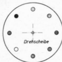
Abb. 2b. Die Bohrungen der Drehscheibe sind mit verschiedenfarbigen Folien überklebt, um einen automatischen Farbwechsel zu erhalten.
