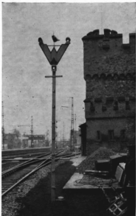
Abb. 1 (unten). Beleuchtetes Wartezeichen Ra 11 (neue Ausführung) mit Sh 1 (in dieser Verbindung = „Auftrag des Wärters zur Rangierfahrt“).
