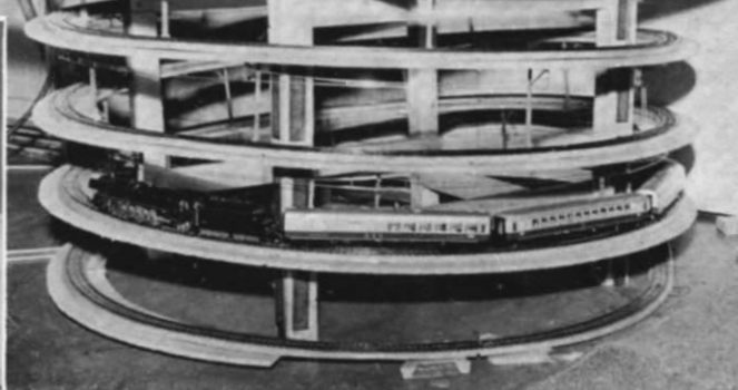
Abb. 5 u. 6. Die zum Fußboden-Abstellbahnhof II führende Spiralwendel.
