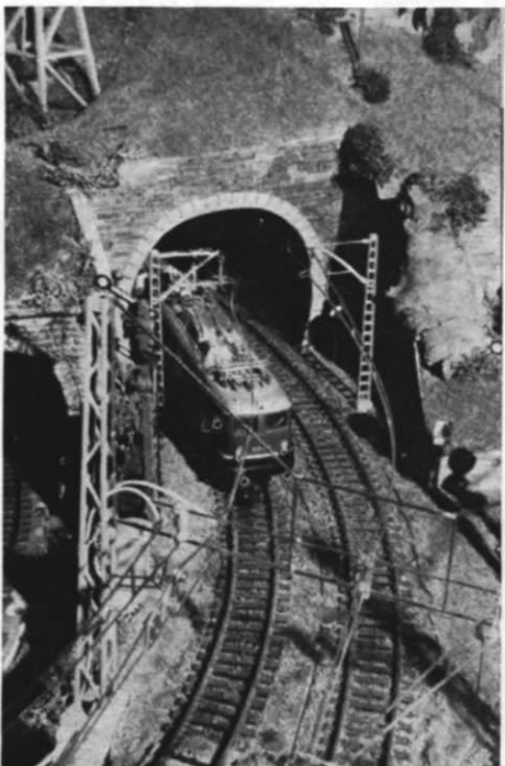
Abb. 12. „Ein paar Meter weiter unten“: Einfahrt in den Tunnelberg. Trotz des engen Gleisabstandes von 5 cm (von Mitte zu Mitte) fahren hier zwei Züge mit 27,5-cm-Wagen anstandslos aneinander vorbei.
