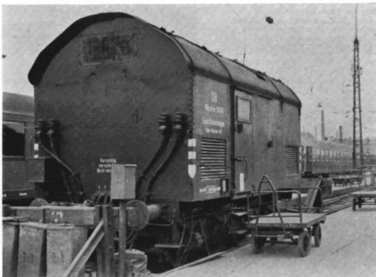
Abb. 2. Der elektrische Vorheizwagen, den Herr H. Stange in Münchner Hbf. entdeckt und fotografiert hatte und der als Vorlage für die nebenstehende Zeichnung diente.
