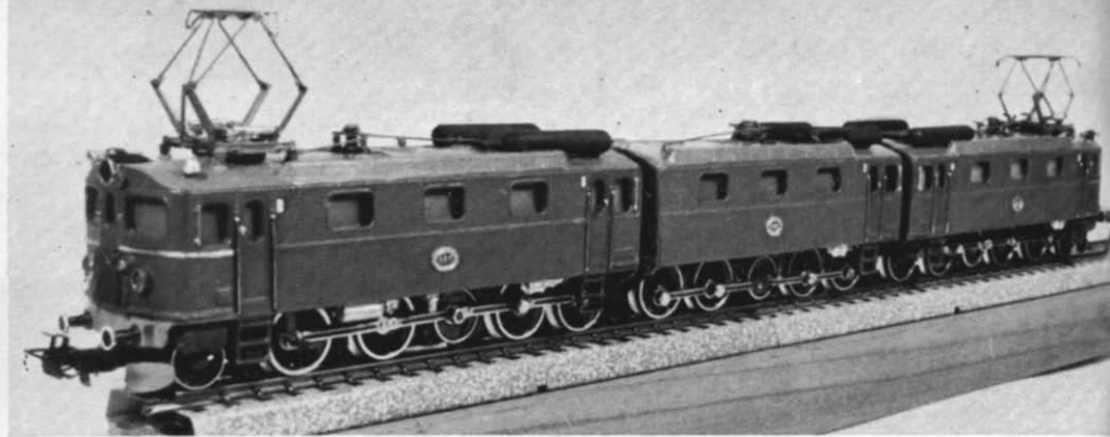
Schwedische Erzzuglok BR DM 23. Dieses effektvolle H0-Modell baute Herr R. Jirowitz, Hanau, aus Märklin-Teilen; es hat 2 Motore, gefederte Achsen und benötigt einen 76-cm-Gleisradius.
