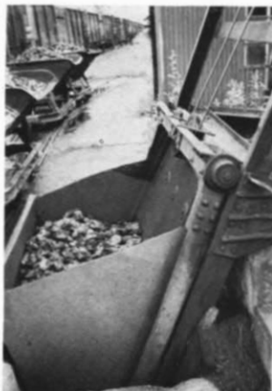
Abb. 9. Der Förderkübel in Großaufnahme. Deutlich erkennbar sind die Verstärkung des Kübelrandes, die Führungsrollen und die Seilführung in der Mitte der Quertraverse.
