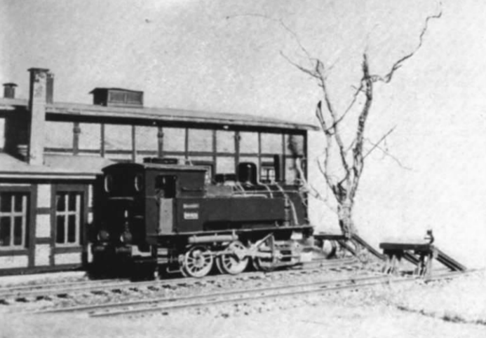
Abb. 6. Auf dem Abstellgleis (mit dem „geschwungenen“ Prellbock aus der MIBA) eine halb fertige bayerische R 3/3. Beim Durchblättern von Unterlagen stieß ich auf ein Foto und die Maßskizze der bayerischen R 3/3. Und siehe da, die Abmessungen stimmen ziemlich gut mit denen der Fleischmann-T3 überein. So begann ich mit meinem ersten Lokbau. Verlängerung der Wasserkästen, Absägen des Schornsteins, andere Lampen und Pufferbohlen, Stangenpuffer, Luftkessel, neue typische Trittbretter beim Führerhaus, und schließlich eine gänzlich neue Steuerung und Zylinder (alles Selbstbau) verändern die Lok zu ihren Gunsten, wie ich meine. — Der dürre Baum entstand, übrigens nach einer MIBA-Anregung, aus einer Wurzel.
