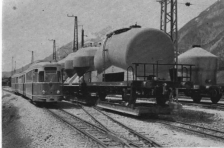
Abb. 4. Größenvergleich zwischen verladenen Betonwagen und einem diesel-elektrischen VT 1 der ZB (ex ET 195 01 + 02 der DB, ex 17.01, 17.02 + Dieselgeneratorwagen-Neubau 17.00 der Rotterdamsche Tramweg Maatschappij, Spurwechsel 1000 mm bei der DB, Ravensburg — Baienfurt, 1067 mm in Holland, Umbau auf 760 mm für die Zillertalbahn — eine wahrlich weit herumgekommene und „mitgenommene“ Triebwageneinheit! Dies nur nebenbei.
