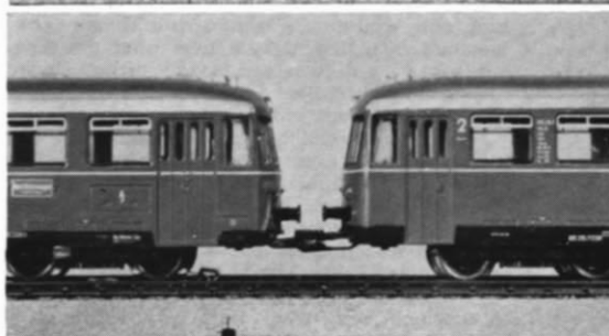
Abb. 2 u. 3. Unterschied zwischen der normalen und einer verkürzten Kupplung.
