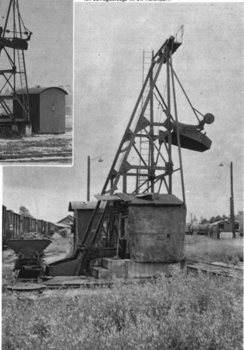
Abb. 12. Schrägaufzug mit seitlichem Elektroantrieb (in dem „verhauten“ Brettverschluss) im Bw Aulendorf. Dieser Schrägaufzug dient zwar zur Bekohlung, aber er könnte ebenso gut als Schlackenaufzug eingesetzt werden. Die Schütte könnte dann entfallen und der Kübel würde in einer Schlackengrube stehen. Genauso gut kann auch der Schrägaufzug unserer Bauzeichnung Abb. 6 u. 7 für eine Bekohlungsanlage verwendet werden.
