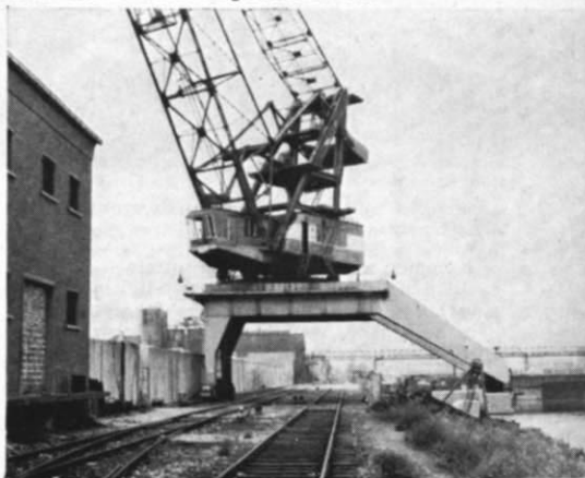
Abb. 16. Detailfahrwerk und Anschluß der beiden Lenker des in Abb. 14 vorgestellten Krans.
