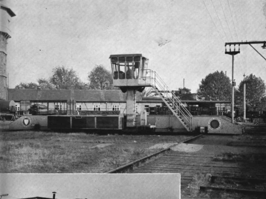
Abb. 15 u. 16. Das Vorbild unseres Bauplans, die Schiebebühne der Maschinenfabrik J. Vögele AG, Mannheim, die zwar für das Verschieben von Waggons gedacht ist, von uns jedoch zu einer Lok-Schiebebühne umgemodelt worden ist. Hier die beiden unterschiedlichen Seitenansichten. Aus Abbildung 15 geht außerdem deutlich der Stromabnehmermast hervor, während auf Abb. 16 die Leitungsmaste ganz gut erkennbar sind. (Werkfotos Vögele, Mannheim)
