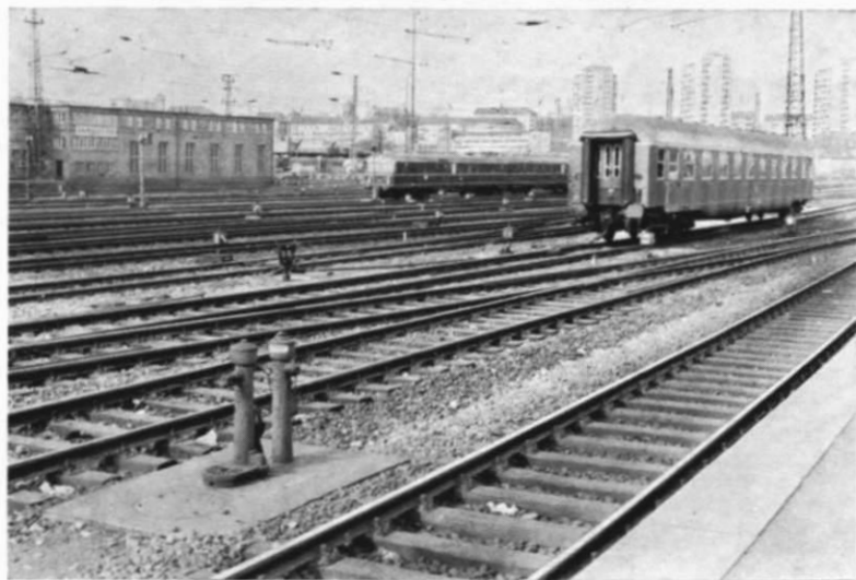
Abb. 20. Ein wei- teres Motiv vom Stuttgarter Hbf: ein bereitgestell- ter Wagen, eben- so wie die obigen Einheiten durch Gleissperren gegen unbe- absichtigtes Ab- rollen gesichert. Im Hintergrund ein abgestell- ter 425 (ET 25), mit eingezoge- nen Stromabneh- mern.
