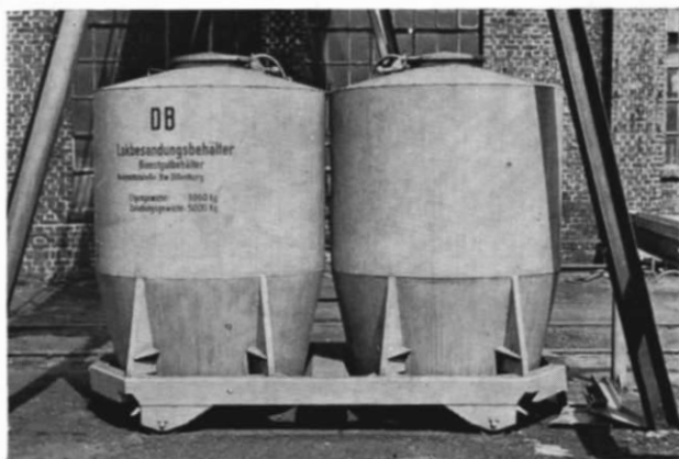
Abb. 7. Keine neuen Raumkapseln, sondern Lokbesandungsbehälter neuerer Art, die Herr R. Vogel aus Düsseldorf im Bw Dillenburg entdeckt hat. Leider konnte er nichts Genaueres in Erfahrung bringen.
