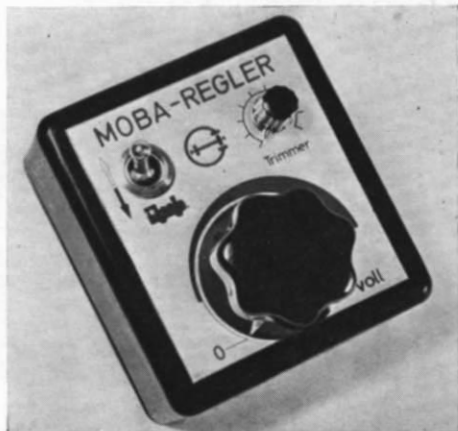
Abb. 1 u. 2. Das Äußere und das Innere des „kleinen“ Moba-Reglers. Mit dem großen Reglerknopf (4 cm Ø) ist ein sehr feinfühliges Steuern möglich.
