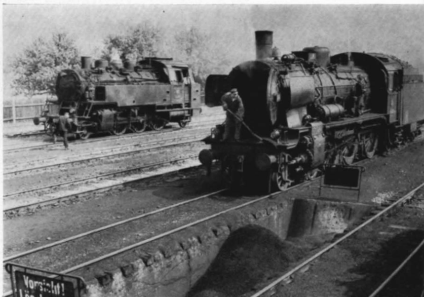
Abb. 19. „Vor- sicht! Löschrube“ steht auf den beiden Schild- ern. Die Rauch- kammer einer „38“ wird gerade von Asche ge- säubert. Und da- mit sie vom Wind nicht in alle Winde ver- weht wird, wird die noch heiße Asche (Lösche) mit Wasser über- gossen.
