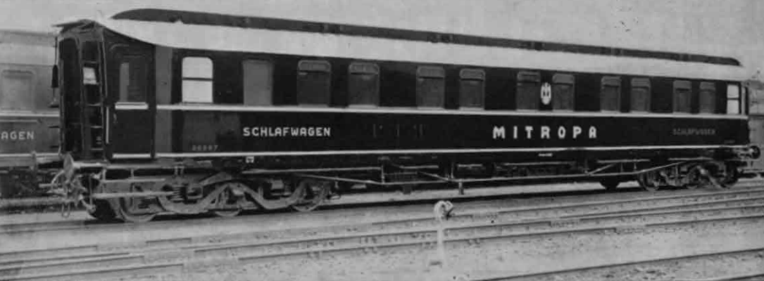
Abb. 1. Schlafwagen der späteren Gattung WL6ü in der Mitropa-Ausführung mit verstärktem Sprengwerk und Lüfterleisten über den Abteilenfenstern (s. hierzu auch Zeichnung Abb. 4). Foto: Lokbildarchiv Bellingrodt.
