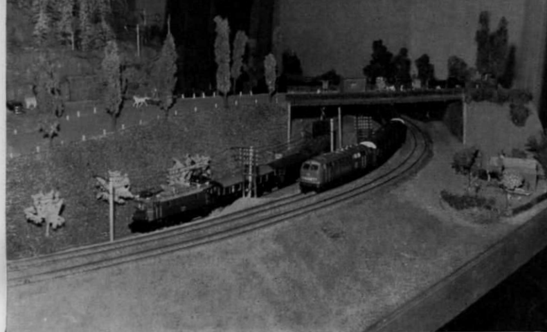
Abb. 4. Motiv an der zweigleisigen Hauptstrecke mit der tiefer gelegenen Nebenstrecke mit Sommerfeldt-Oberleitung. Die hier eingebauten Gleise mit 2,7 mm-Stahl-Profil werden in Bälde durch Betonschwellengleise von Peco ersetzt.
