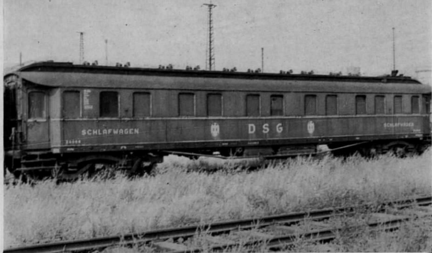
Abb. 16. Ein WL6ü in DSG-Ausführung als Wohnwagen eines Bauzugs. Die Verlegung der Dachlüfter auf dem oberen Aufsatz entspricht nicht dem Originalzustand, sondern stellt eine der vielen Änderungen dar, die im Laufe der Betriebsjahre durchgeführt wurden. (Foto: Ostendorf)
