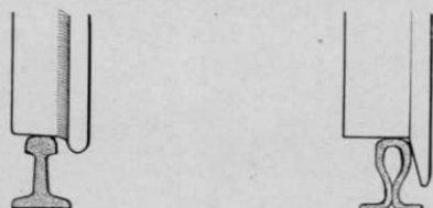
Abb. 3. RP 25-Rad und Schienenprofil im Vergleich zu einem Spielzeugrad mit Freelance-Schiene. Die Ausrundung beim RP 25-Rad hat nur Sinn in Verbindung mit einem vorbildgerechten Schienenprofil (wobei die Höhe des Profils keine Rolle spielt), andernfalls wäre ein höherer Spurkranz besser.
